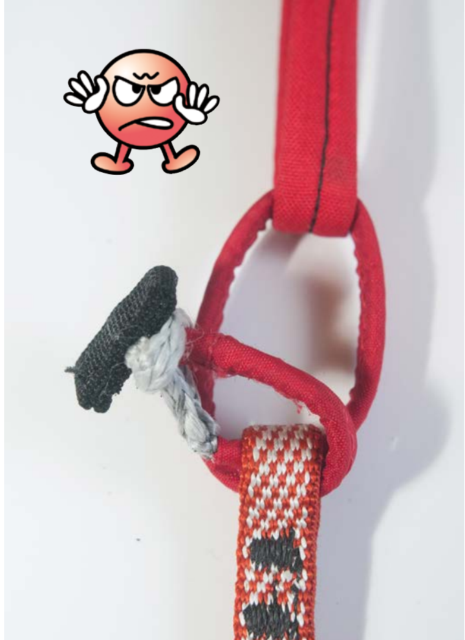
Auch dieser Softlink ist zwar ordnungsgemäß verschlossen, aber nur einmal tragend geschlaucht: Er hält so nur die Hälfte der angegeben Bruchlast.
