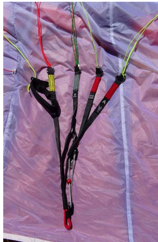
Relativ wenig Leinen, ein leicht zu begreifender Gurt, der zudem noch mit klaren Beschriftungen versehen ist (A, B, C...)
