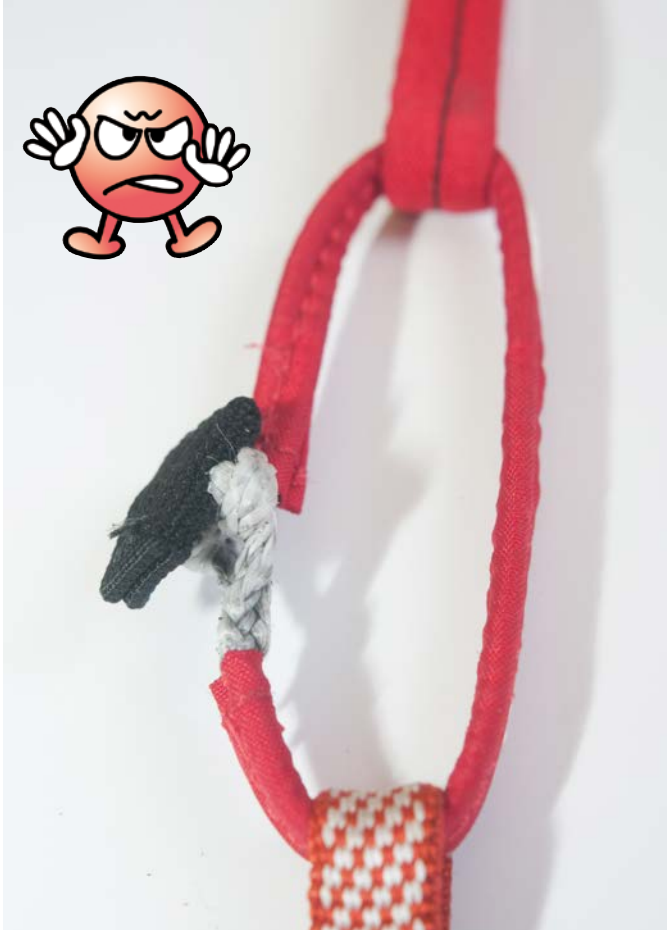
Genau wie in 1: Ordentlich verschlossen, aber nur halbe Bruchlast.
