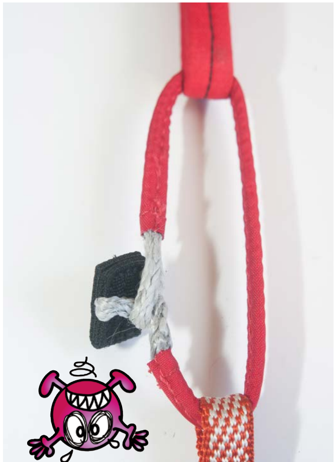
Noch schlimmer: falsch verschlossen und halbierte Bruchlast.
