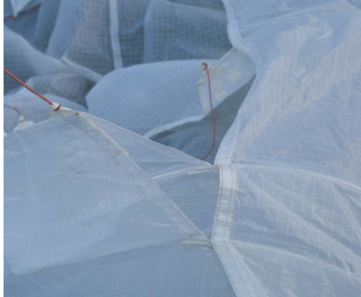
Air Design UFO im Detail : trotz des minimalistischen Kappenprinzips gab sich der Hersteller sichtlich Mühen. Auch an die Langlebigkeit wurde sichtlich gedacht, unter anderem sind die Rippen an den Schnitträndern eingefasst.
