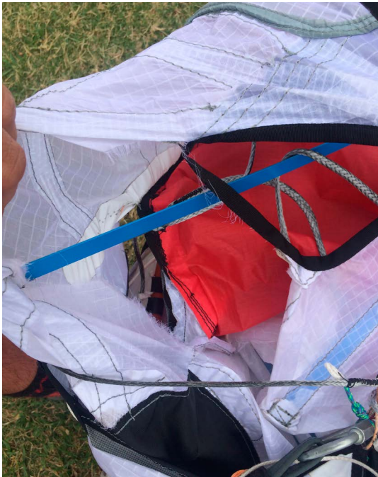
Einer der ersten Prototypen: das Tuch geht in, Fetzen, nicht aber der sicherheitsrelevante Rest. Foto : Kortel
