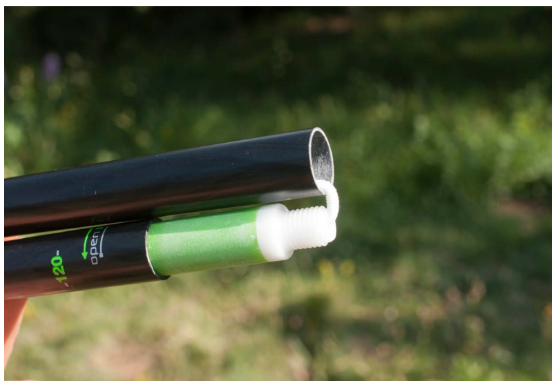
Einige Drehungen, und der Stock ist "zerkleinert". Praktisch, aber uns ist ein Fall bekannt, wo sich die Klebung der weißen Schraube im grünen Schaft gelöst hat. Das lässt sich aber leicht reparieren.
