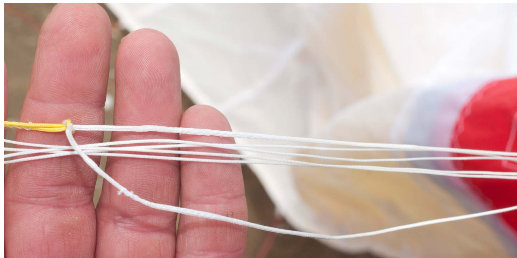
Für "nackte" Leinen nutzen die Hersteller beispielsweise Dyneema (oben) oder Aramide (unten). Dyneema ist oft weiß und die anderen Fasern oft braun, aber das ist nicht immer so, die Farbe ist kein eindeutiges Merkmal. Dyneema ist weniger formstabil.
