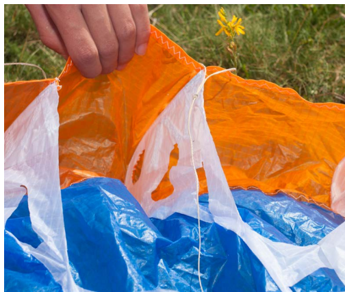
Details des Skin Plume : ein Teil der guten Profiltreue ist sicherlich auf die Metalldrähte aus Nitinol sowie die präzise Verarbeitung zurückzuführen.
