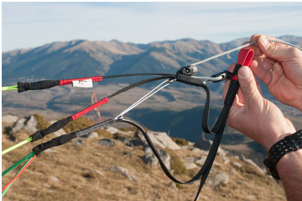
Ungewöhnlich: die Platzierung und die Krümmung der Kunststoffdrähte.
