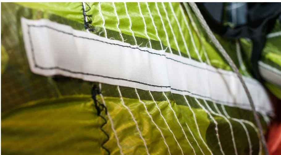
Latten gegen Kompressionskräfte.
