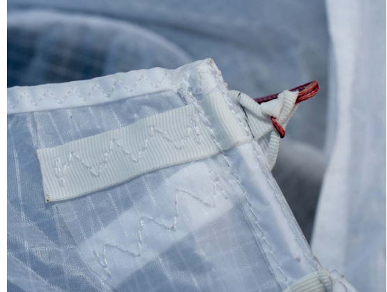
Air Design UFO im Detail : trotz des minimalistischen Kappenprinzips gab sich der Hersteller sichtlich Mühen. Auch an die Langlebigkeit wurde sichtlich gedacht, unter anderem sind die Rippen an den Schnitträndern eingefasst.
