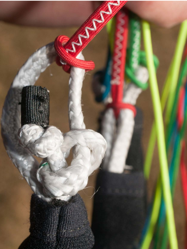
Sittas' Softlinks sind anders gestrickt als bei anderen Schirmen: Ein Ankerstich umschlingt die lose Part, die in einem Stopknoten endet.
