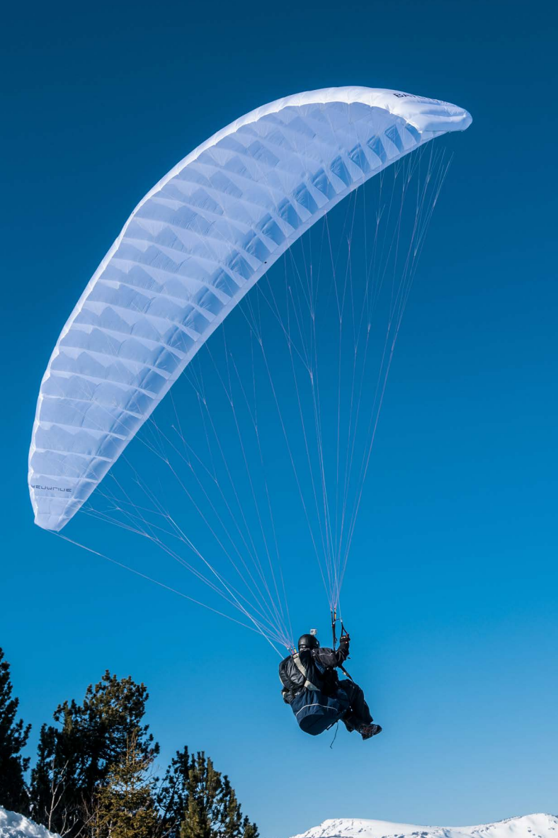
Der Batlite von Adrenaline basiert auf den Barretina-Plänen. Hier fliegen wir ihn bei unseren Tests im Jahr 2013. Der Batlite ist eines der leistungsschwächsten Einfachsegel, aber auch das "zähmste". Foto : Véronique Burkhardt
