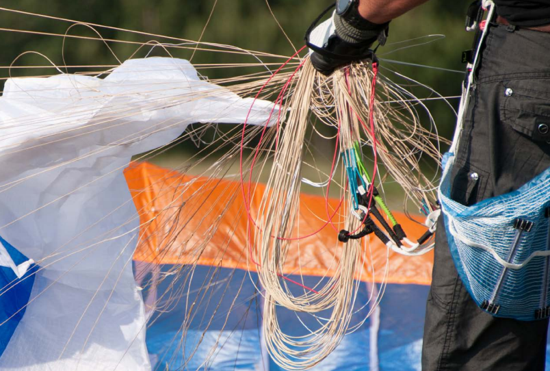
Die geschmeidigen, unummantelten Leinen des Skin Plume sind einfacher zu entwirren .....
