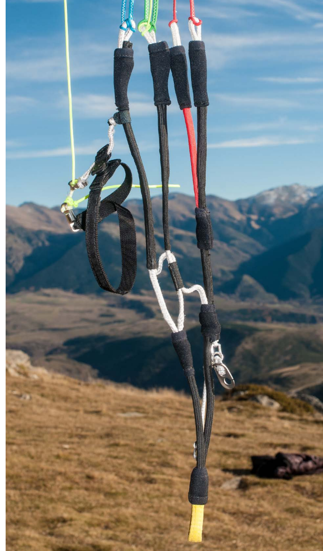
Die Gewichtsersparnis wurde mittels leichterem Tuch und auch dank dieser Dyneema-Tragegurte erreicht.
