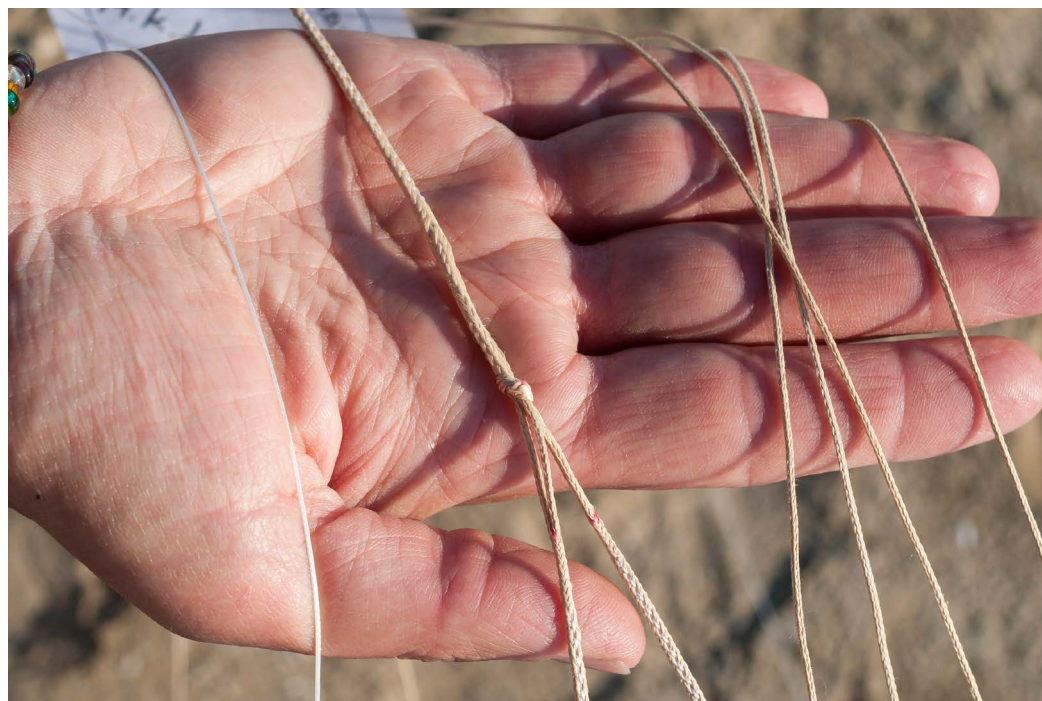
Für "nackte" Leinen nutzen die Hersteller beispielsweise Dyneema (oben) oder Aramide (unten). Dyneema ist oft weiß und die anderen Fasern oft braun, aber das ist nicht immer so, die Farbe ist kein eindeutiges Merkmal. Dyneema ist weniger formstabil.
