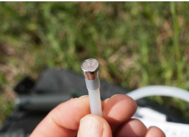
Der Ansaugschlauch mit Vorfilter.
