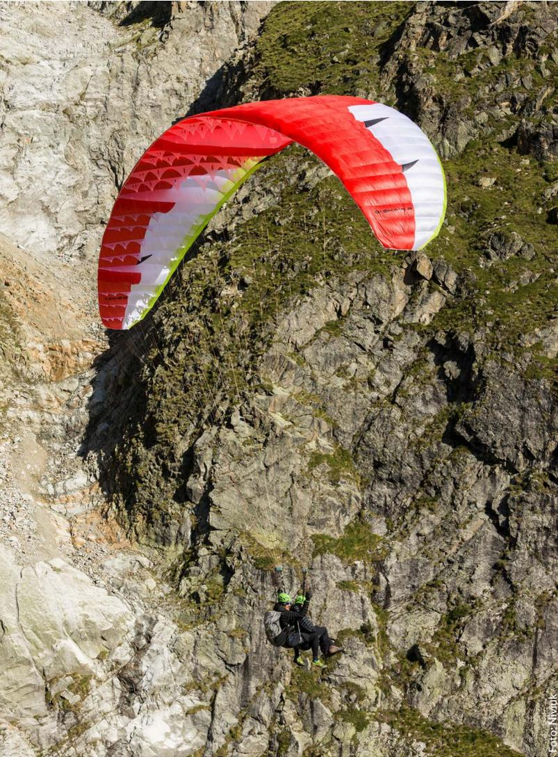
**Niviuk Bi Skin 2 P (2016)** : die Eintrittskante wird von Nitinol-Drähten aufgespannt, die Kammern haben eine Shark Nose.
