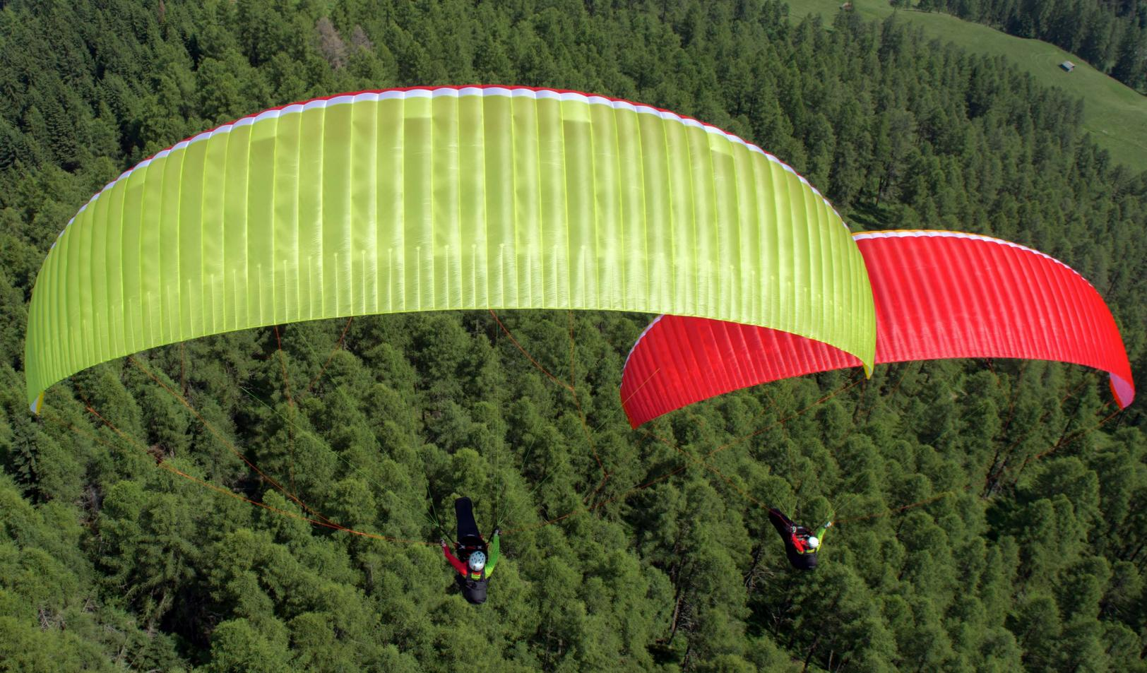
Ganz transparent und gut sichtbar: Mini-Ribs an der Austrittskante und sehr "luftig-leicht" geschnittene Diagonalzellen.
