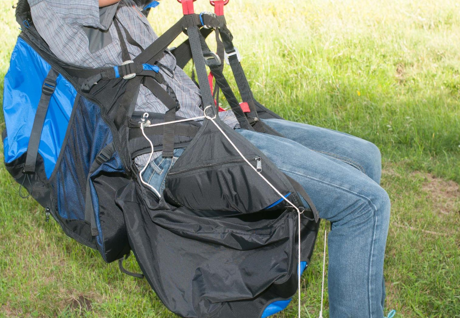
Ein modulares System: der Airbag und das Helmfach sind abnehmbar.
