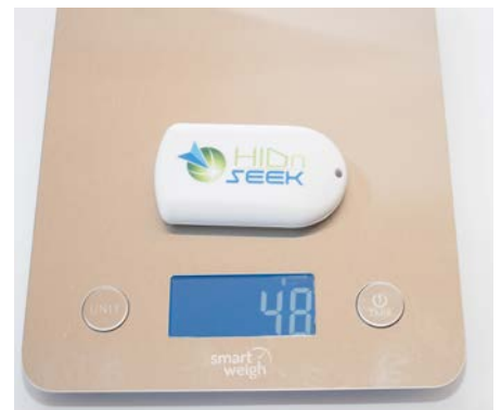
HidnSeek GPS Tracker ST-1A (Abmessungen: 85x48x15mm, Gewicht 48 g, 139 €, 20€ Jahresgebühr.
