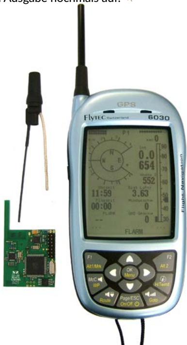
Das FLARM-Modul des älteren Flytec 6030 ist nicht mit dem neuen Connect kompatibel, für dieses soll es bald ein spezielles Modul geben.
