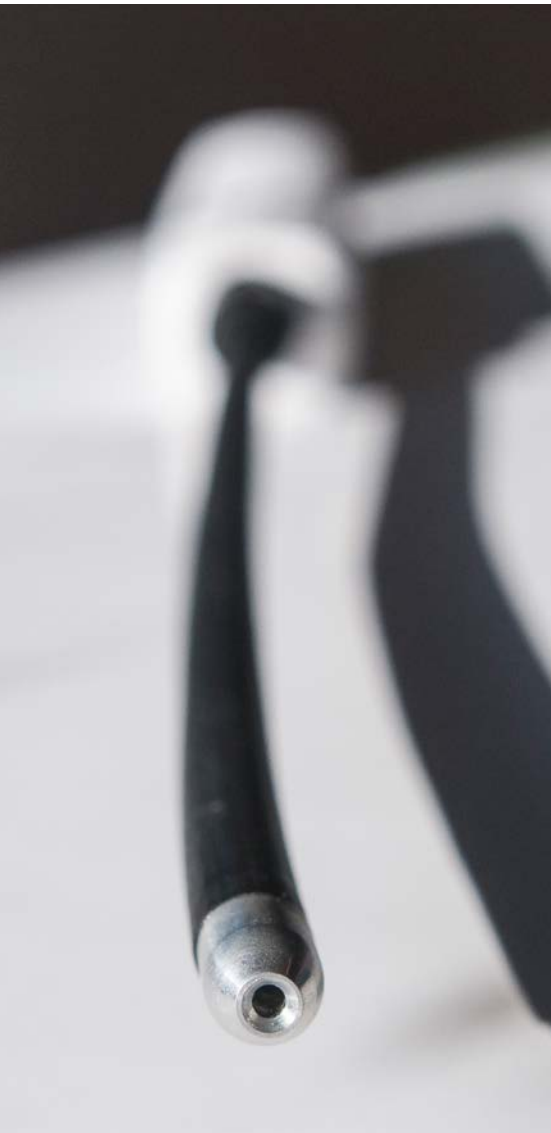
Die Öffnung des Pitot-Rohres des C-Probe.
