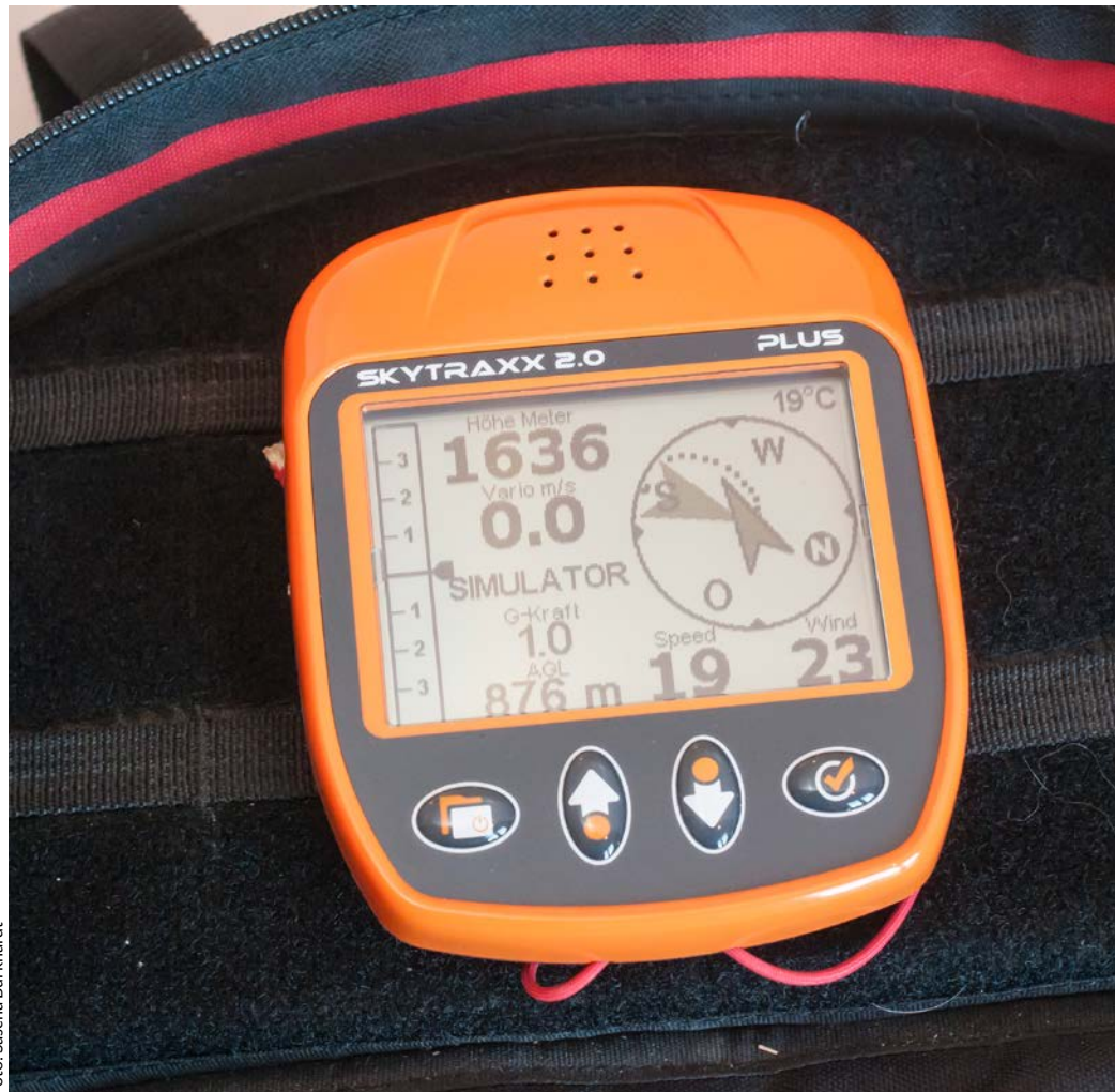
Das Display ist gut lesbar, die Aufteilung der Informationen gut durchdacht. Natürlich zeigt das Instrument auch Windgeschwindigkeit und -richtung an.
