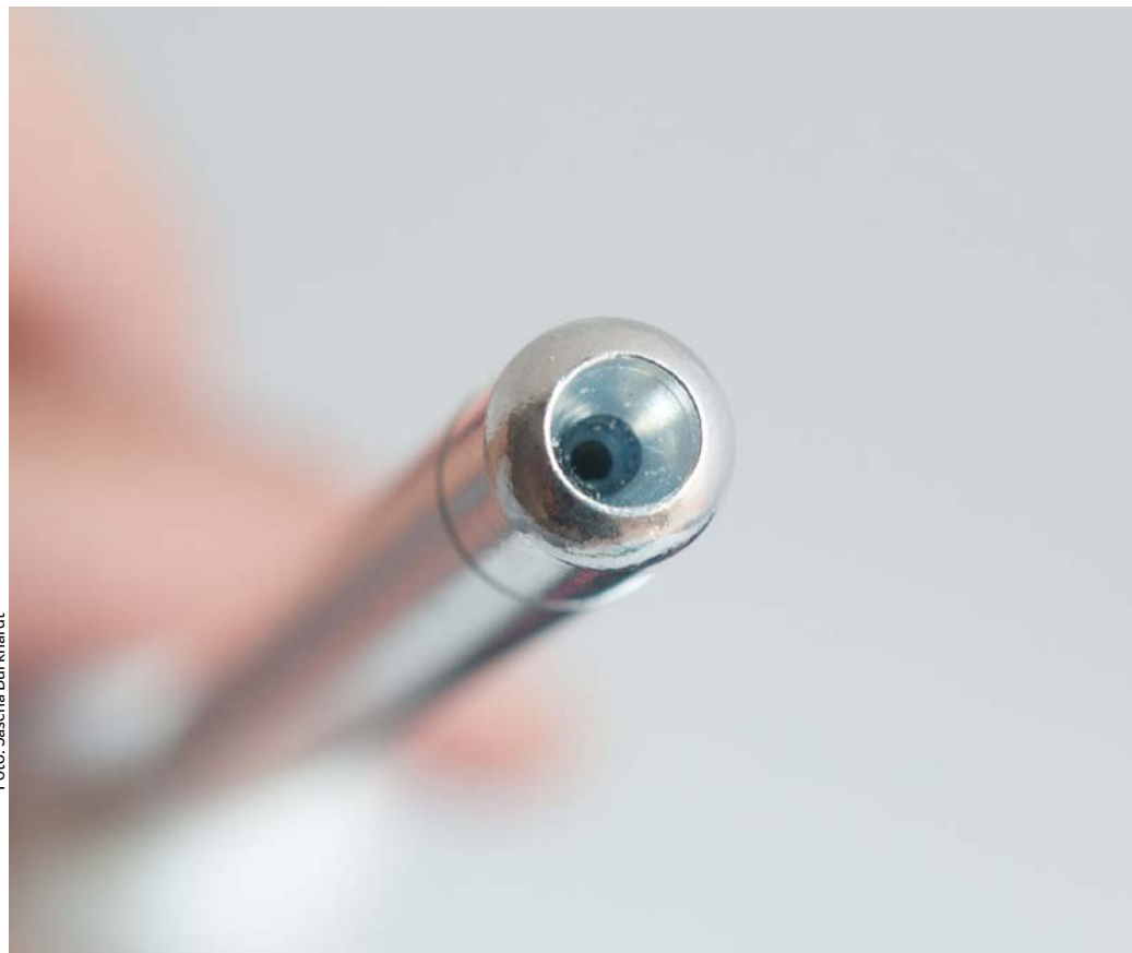
Der Lufteintritt an der Spitze des Pitotrohrs von Flymaster.
