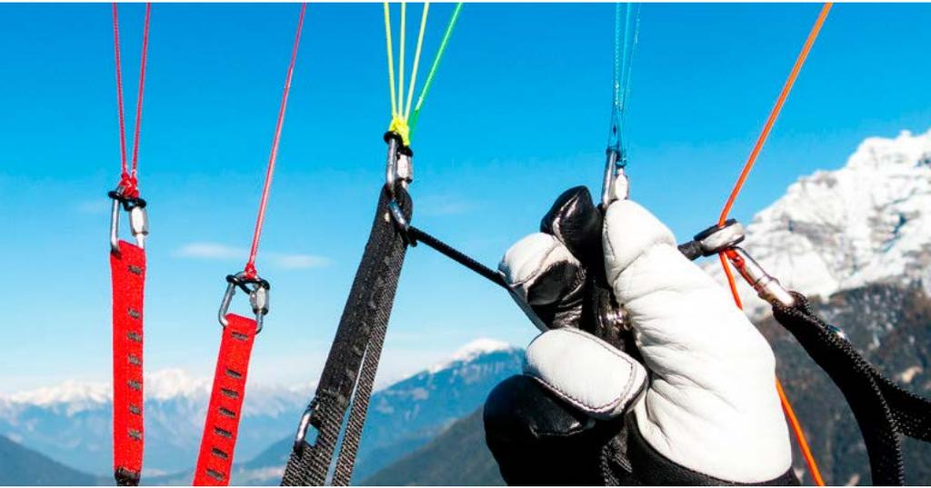
Der Pilot kann den Ion 4 auch mit dem System "Speed-Brake-Riser" von Nova bestellen. Es handelt sich dabei um eine neue Steuerhilfe, die das Agieren auf den C-Gurten erleichtert. Dabei werden nicht nur die C verkürzt, sondern auch die B: Das ist sinnvoll, um die Kappe abzubremesen, ohne die Profilform allzu sehr zu verbiegen, was Leistung kosten würde.
