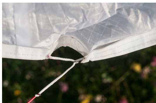
Das Raffsystem der Steuerleinen-Anlenkung.
