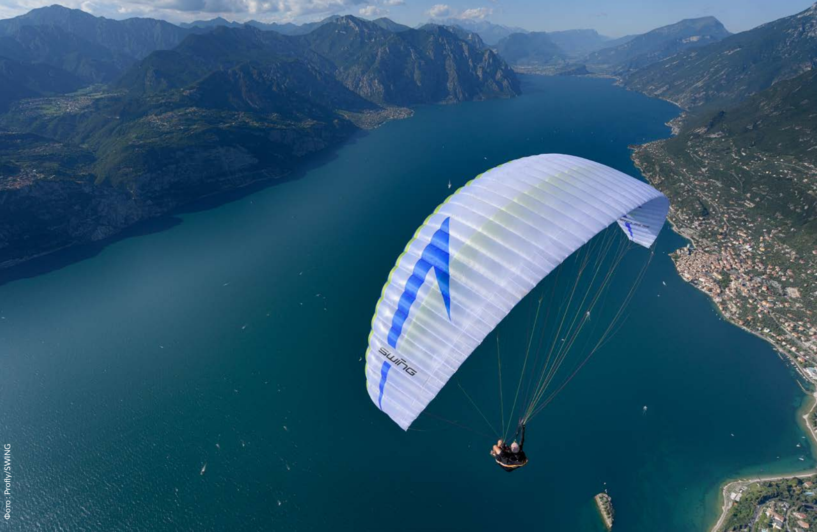
Параплан Arcus RS Lite: "лонжерон" системы RAST чётко виден в середине крыла
