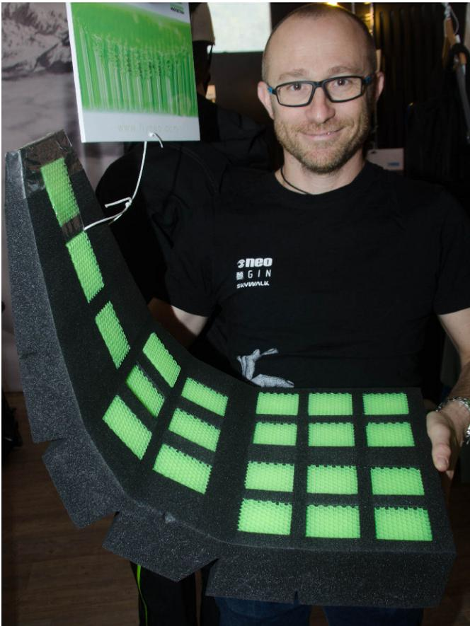
Leicht und widerstandsfähig: Die Röhren aus extrudiertem Kunststoff garantieren die Formbeständigkeit der Sitzfläche. Ab einer bestimmten Stoßkraft fängt das Material den Aufprall ab und verformt sich dauerhaft zum Schutz des Piloten (rechts). Danach müssen diese Würfel ausgetauscht werden. Das soll die Wirbelsäule wert sein.
