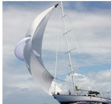
Der Parasailor ist ein interessantes Beispiel für disziplinübergreifende Entwicklung: solche Spinnaker entlasten dank einer eingebauten "Schirmkappe" den Bug. Segler Sascha aus der free.aero-Redaktion bestätigte nach Vergleichstests die Effizienz dieser Technik.
