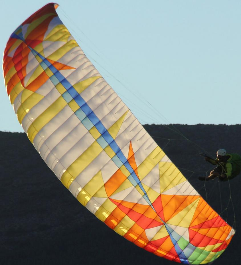
Der "Low-EN B" Echo, die Leichtversion des Epic, mit ausgeprägter Sharknose, Mini-Ribs, CCB (3D-Shaping) und einem originellen Dessin.
