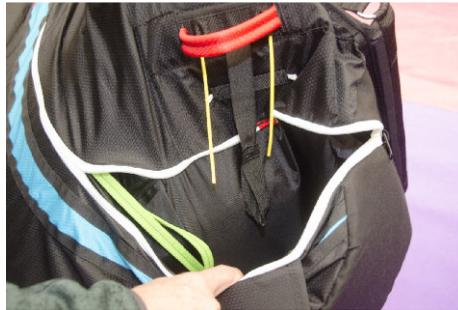
Mit einem Reißverschluss verschlossener Rettercontainer. Der Auslösegriff ist durch ein Band mit dem Innencontainer verbunden.
