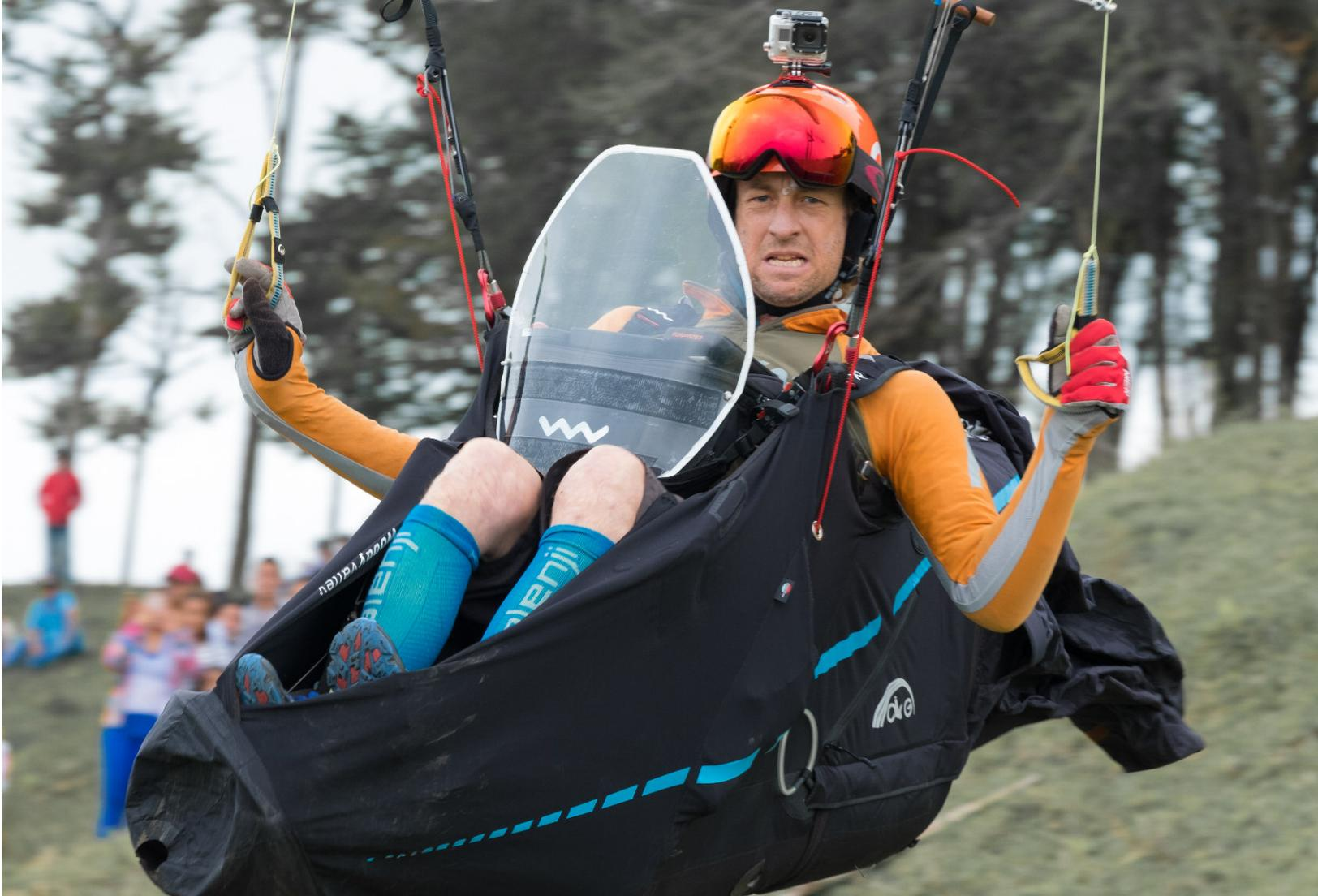
Der neue Woody Valley X-Rated 7. Gut sichtbarer Unterschied zur Version 6: Die Heckflosse läuft weniger spitz aus.
