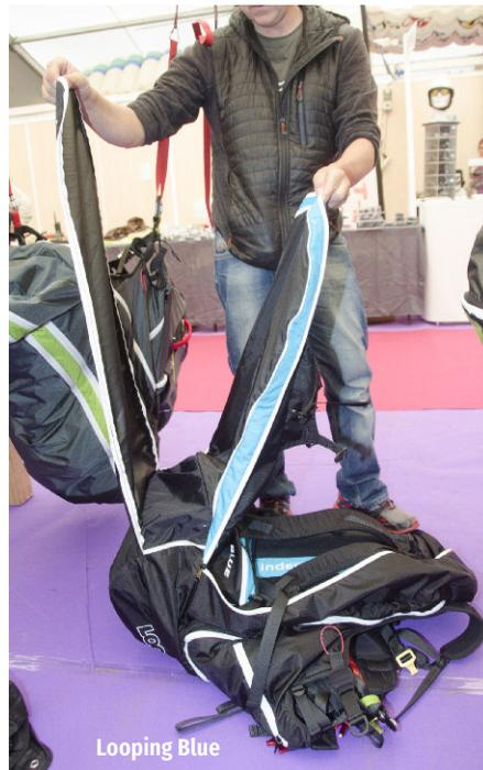
Ein sinnvolles Detail aller neuen Independence-Gurte: die Seitenmarkierung rechts/links. Sie hilft auch fortgeschrittenen Piloten bei der schnellen Startvorbereitung, insbesondere beim Aufziehen mit dem Rücken zum Wind.
