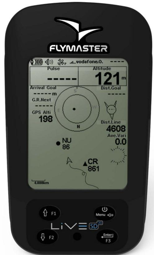
Die Buddies-Funktion steht seit Ende Oktober auf den mit einer SIM-Karte ausgestatteten Flymaster-Instrumenten zur Verfügung. Die Piloten sehen sich gegenseitig auf den Displays. Hier ist der Pilot NU86 auf dem Boden, der Pilot CR861 fliegt.
