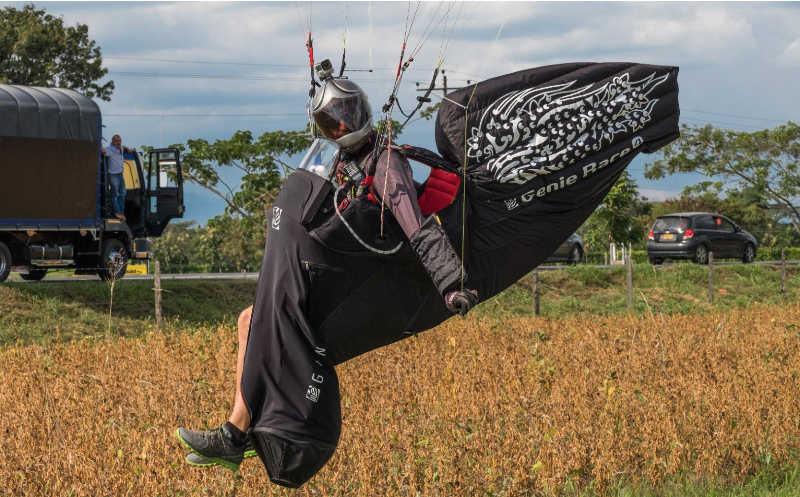
Das neue Genie Race 4 bei der Landung. Die Windschutzscheibe ist ein offizielles Accessoire dieses Gurtzeugs und soll die Windschlüpfrigkeit noch weiter verbessern. Das aerodynamische Heckteil wird über einen Schlauch belüftet, der in der Fußplatte endet, die Eintrittsöffnung schaut hier nach unten. Der Sitzgurt ist in Kürze in 4 Größen, erhältlich, Gewicht von 7,6 -8,5 kg, 2490 €, <http://gingliders.com/>
