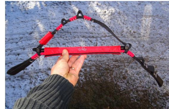
Icaro-Spreize. 235 g einschließlich herausnehmbares Distanzstück. Rechts drei verschiedene Einhängemöglichkeiten für den Passagier.
