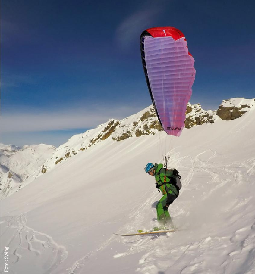
Der Mirage RS: ein Speedriding-Flügel, der mit dem RAST-System ausgestattet ist, das sich bereits bei Gleitschirmen von Swing wie zum Beispiel dem Mito RS und dem Arcus RS als effizient beweisen konnte. Die Schottwand mit Ventilen des RAST ermöglicht, den Staudruck im hinteren Teil des Flügels besser aufrecht zu erhalten.
