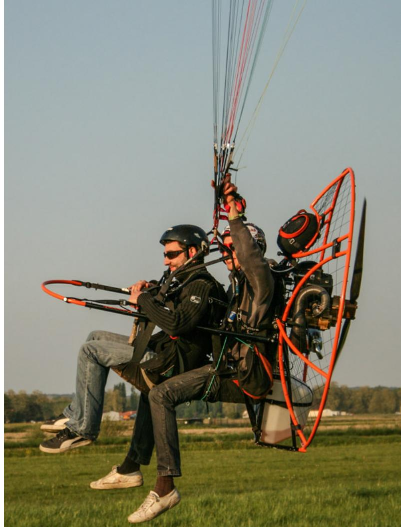
Die Rollbar, hier eine ältere Version von Kangook, soll in erster Linie den Passagier beim Startlauf führen, nach vorne schieben (oder ziehen) und die Befreiheit von Pilot und Passagier gewährleisten.
