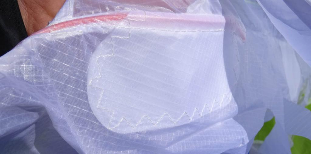
Verstärkungen an der Eintrittskante im Bereich der A-Leinen optimieren die Leistung bei hoher Geschwindigkeit.
