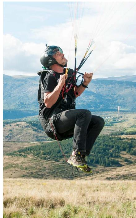
Dabei ist das Groundhandling über die C/D-Ebenen eine sehr wirkungsvolle Methode, um bei stärkerem Wind nicht ausgehebelt zu werden. Denn wenn der Pilot mit den Steuerleinen arbeitet, erhöht er bei jedem Impuls kurzzeitig den Auftrieb, die Kappe zeigt also eine Tendenz, ihn in die Höhe zu reißen.
