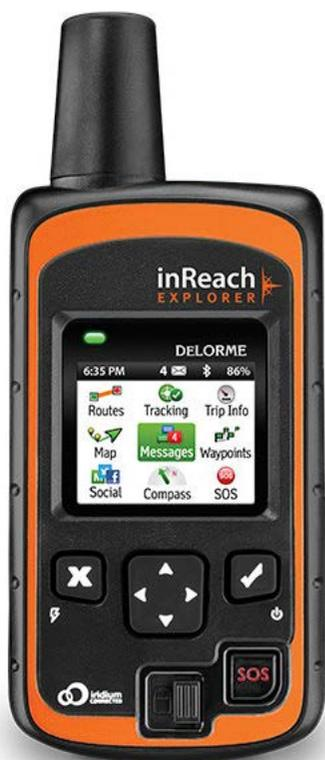
Der neue inReach Explorer kann zusätzlich auch als GPS-Handgerät eingesetzt werden, er bietet Waypoint- und Routenfunktionen. Zudem enthält er eine barometrische Sonde und einen elektronischen Kompass.
