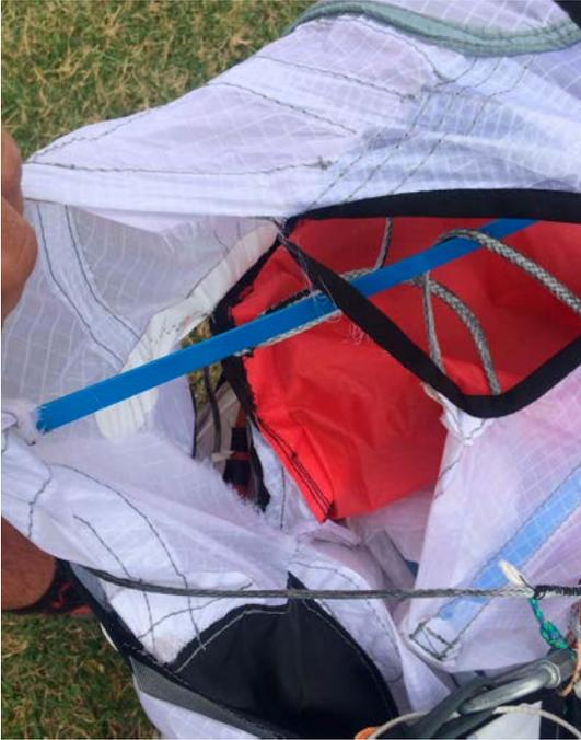
Einer der ersten Prototypen: das Tuch geht in, Fetzen, nicht aber der sicherheitsrelevante Rest.
