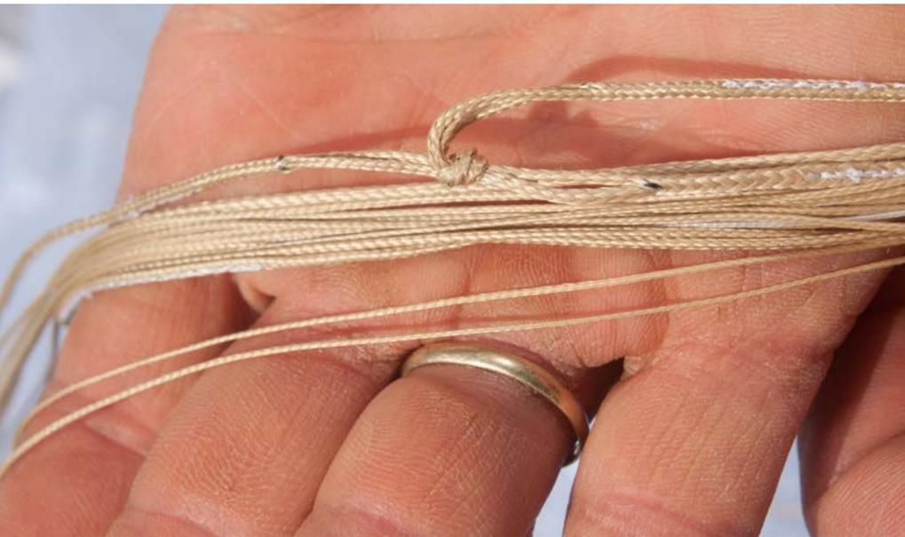
Die Leinen des Niviuk Skin Plume. Sie sind sehr "flüssig" zu sortieren. Ein interessanter Mix aus Vectran 1,4 mm, klassischem Aramid und Dyneema. Vectran ist teuer, hat aber viele Vorteile: hohe Zugfestigkeit, geringe Dehnung, hohe Beständigkeit gegen UV, Scherungen und Wasser, hohe Schmelztemperatur, gute dimensionale Stabilität.
