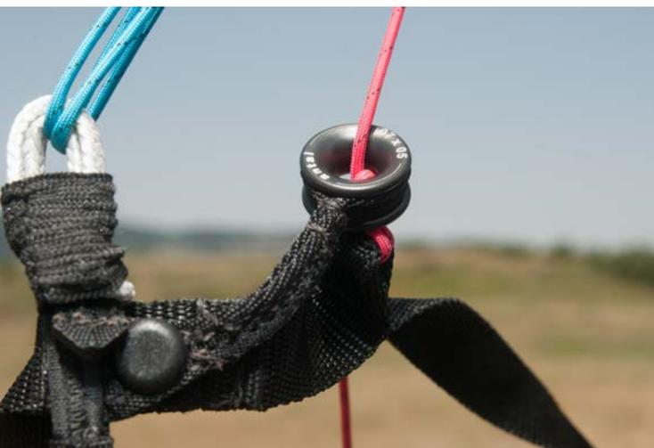
Beim ultraleichten Skin Plume laufen die Bremsleinen durch Keramikringe.
