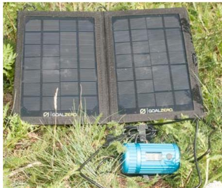
Das lange Kabel ist verschraubt: praktisch, wenn der Akku im Rücken verstaut ist und man aus Versehen mit dem angeschlossenen Telefon am Kabel zerrt. Achtung, ein iPhone-Adapter muss extra gekauft werden. Der Akku ließ sich mit einem Solarpanel nachladen (Goal Zero, 7W, USB-Ausgang, 430g, am Rucksack befestigbar)..
