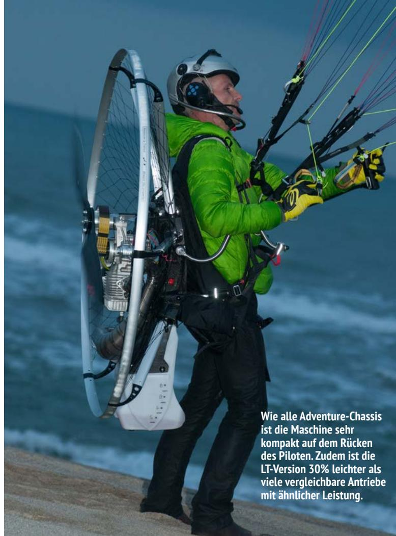
Wie alle Adventure-Chassis ist die Maschine sehr kompakt auf dem Rücken des Piloten. Zudem ist die LT-Version 30% leichter als viele vergleichbare Antriebe mit ähnlicher Leistung.
