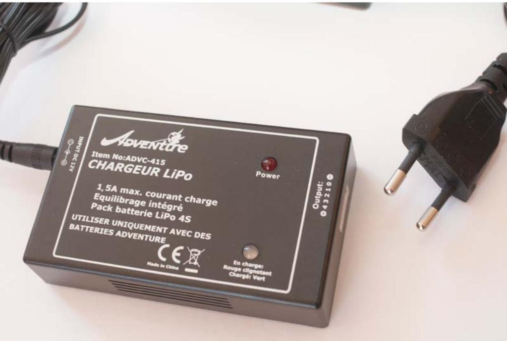
Typisch Adventure: Der Motor lädt die LiPo-Batterie nicht nach, der Pilot muss sie hin- und wieder an die Steckdose anschließen.
