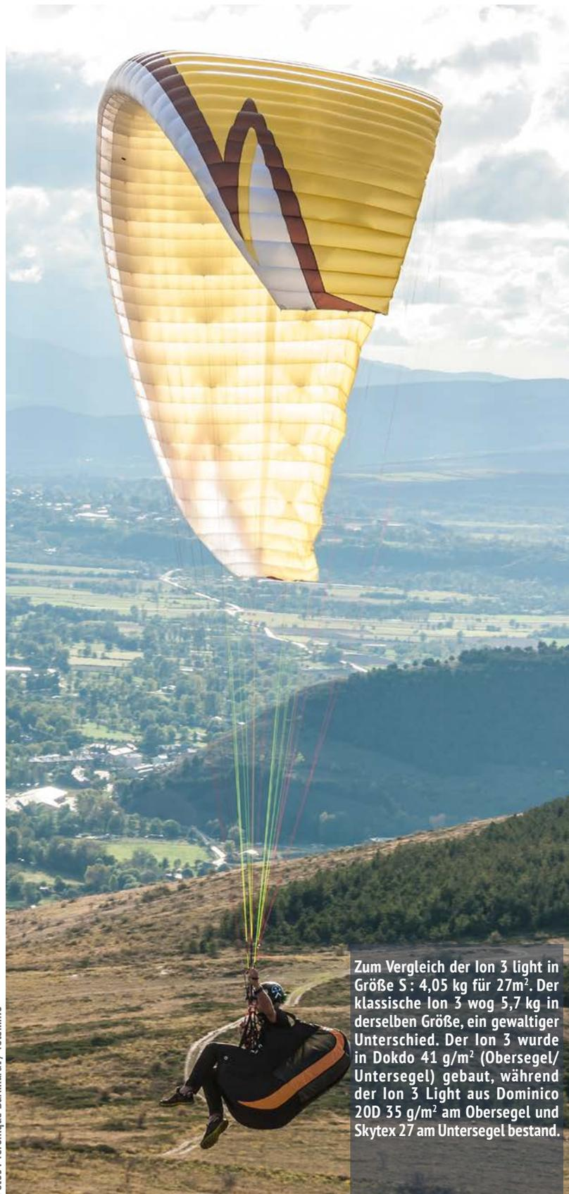
Zum Vergleich der Ion 3 light in Größe S: 4,05 kg für 27m<sup>2</sup>. Der klassische Ion 3 wog 5,7 kg in derselben Größe, ein gewaltiger Unterschied. Der Ion 3 wurde in Dokdo 41 g/m<sup>2</sup> (Obersegel/ Untersegel) gebaut, während der Ion 3 Light aus Dominico 20D 35 g/m<sup>2</sup> am Obersegel und Skytex 27 am Untersegel bestand.
