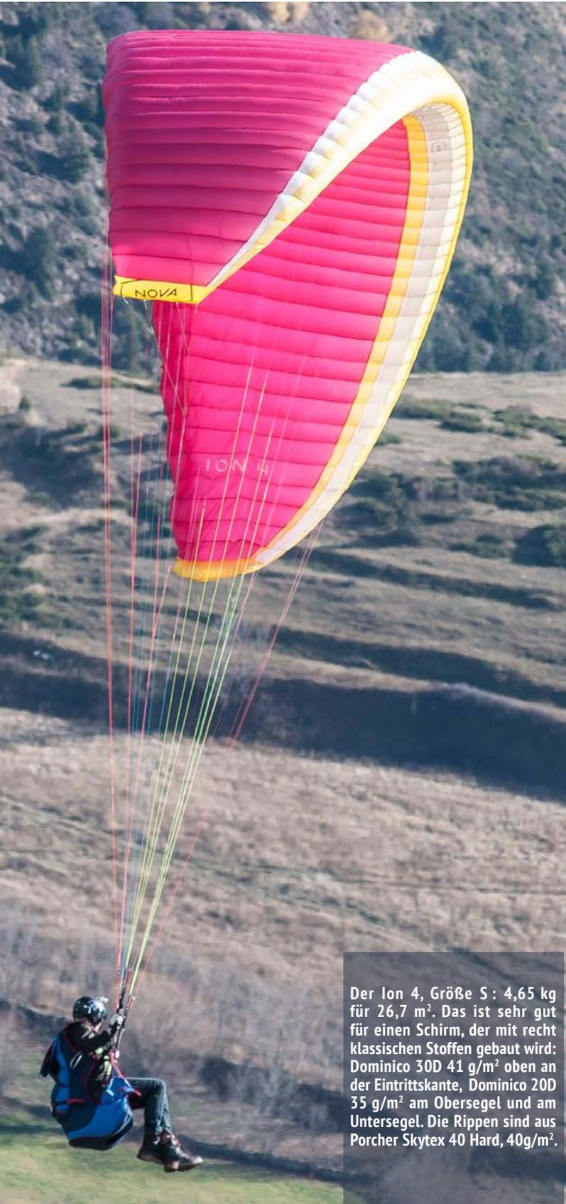
Der Ion 4, Größe S: 4,65 kg für 26,7 m<sup>2</sup>. Das ist sehr gut für einen Schirm, der mit recht klassischen Stoffen gebaut wird: Dominico 30D 41 g/m<sup>2</sup> oben an der Eintrittskante, Dominico 20D 35 g/m<sup>2</sup> am Obersegel und am Untersegel. Die Rippen sind aus Porcher Skytex 40 Hard, 40g/m<sup>2</sup>.
