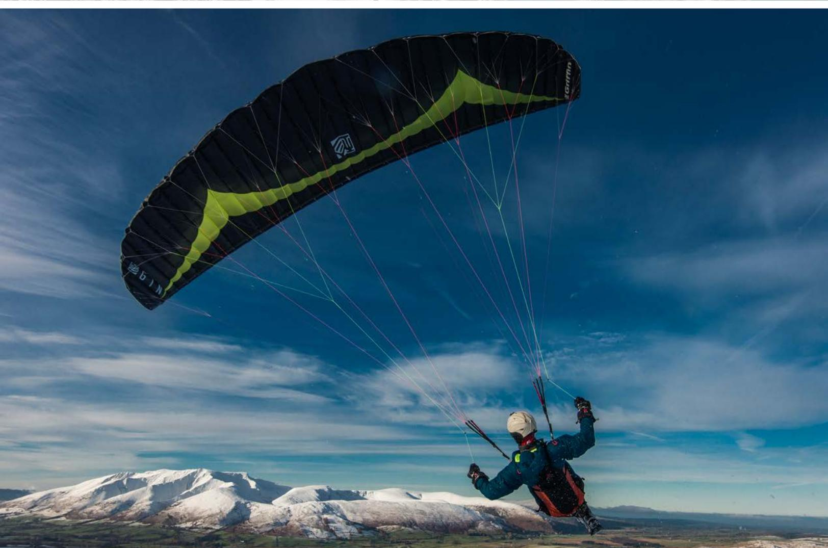
Die Kappe wird in erster Linie aus Skytex 27 g/m<sup>2</sup> gebaut mit Ausnahme der Eintrittskante, die aus Porcher Skytex 32 g/m<sup>2</sup> besteht. Das Kappengewicht ist genial gering: 2,1 kg. Die Tragegurte sind klassisch konstruiert, es ist aber auch möglich, Dyneema-Gurte und Softlinks zu bestellen. 🧗
