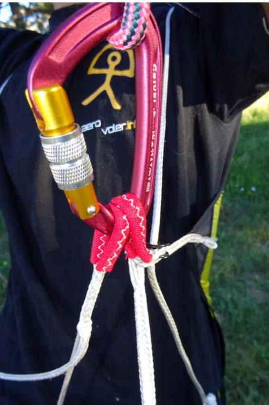
Diese Schlinge kann am Hauptkarabiner befestigt werden und reduziert so die Tiefe des Rückens, d.h. es können zwei verschiedene Positionen eingestellt werden.
