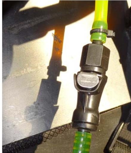
Empfohlenes Accessoire: die Schnelltrennkupplung für die Kraftstoffleitung, für ca. 19 € ebenfalls bei Reuter erhältlich.
