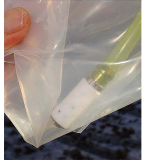
Das Ansaugfilterstück am Boden des Tanks.
