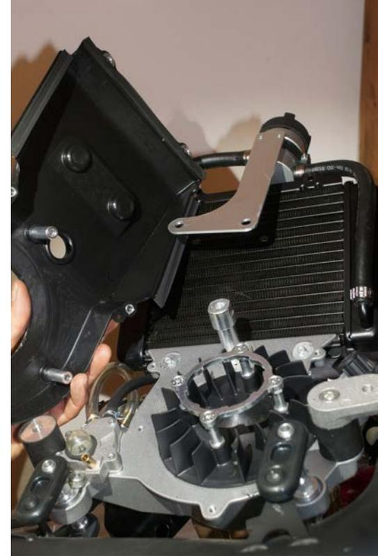
... sowie das Gebläsegehäuse. Unten auf den Bildern der alte und der neue Silent-Block...
