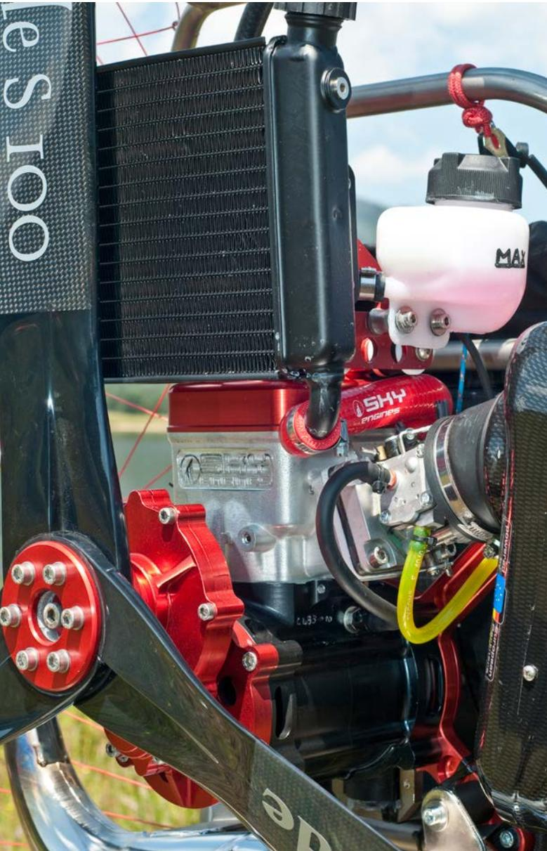
Zum Vergleich ein Sky Motor aus einem unserer älteren Tests. Der größte Unterschied: Der Kühler ist weniger integriert, und er hat keine Umwälzpumpe. Die Zirkulation des Kühlmittels wird alleine durch die Temperaturdifferenz aufrechterhalten. (Thermosiphon-Prinzip)
