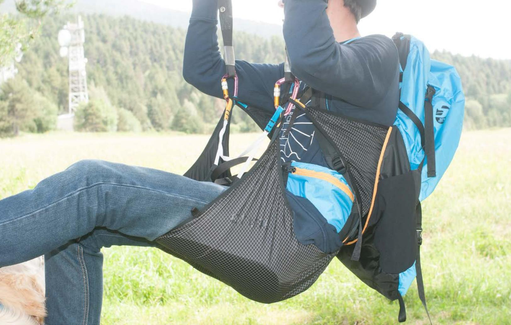
Ein ultraleichtes, in einem Rucksack integriertes Gurtzeug. Achtung: der Pilot auf diesem Foto hatte einen kleinen Fehler gemacht. Der Verschluss gehört andersherum: die vorderen Schlaufen sollten auf derselben Farbe eingehängt werden.
