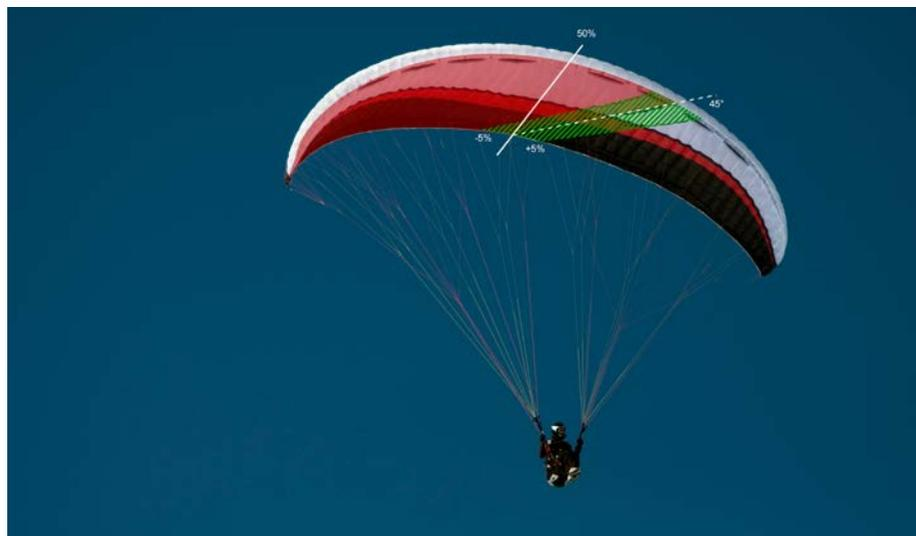
Die Definitionen von einseitigen Klappern bei den Homologierungs-Tests haben sich geändert. Oben ist alles, was beim großen Klapper nach der EN von 2005 "verschwinden muss", rot eingezeichnet, grün ist die erlaubte Toleranz.
