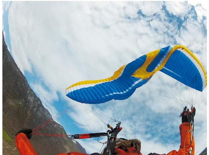
Hier dieselbe Kappe in einem "großen Klapper". Auch hier bleibt der DHV-Pilot perfekt an den Vorgaben. Doch ist das bei allen Kappen immer ohne Faltleinen möglich, und verhält sich die Kappe nach dem A-Gurt-Zug wirklich wie beim echten Klapper in freier Wildbahn?
