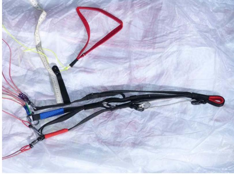
Das differenzierte Bremsverhalten in Abhängigkeit von der Bremszug-Richtung ist hier sehr effizient. Da ist sicherlich auch die ungewöhnliche Anlenkung der Bremsspinne daran beteiligt. Beim Vita 2 sind die Raffbänder zum Beispiel in der Mitte und nicht außen angebracht. Anderer kleiner Bonus: deutliche Kennzeichnung der Kappenmitte auch an der Austrittskante. Praktisch beim Falten und am Start.
