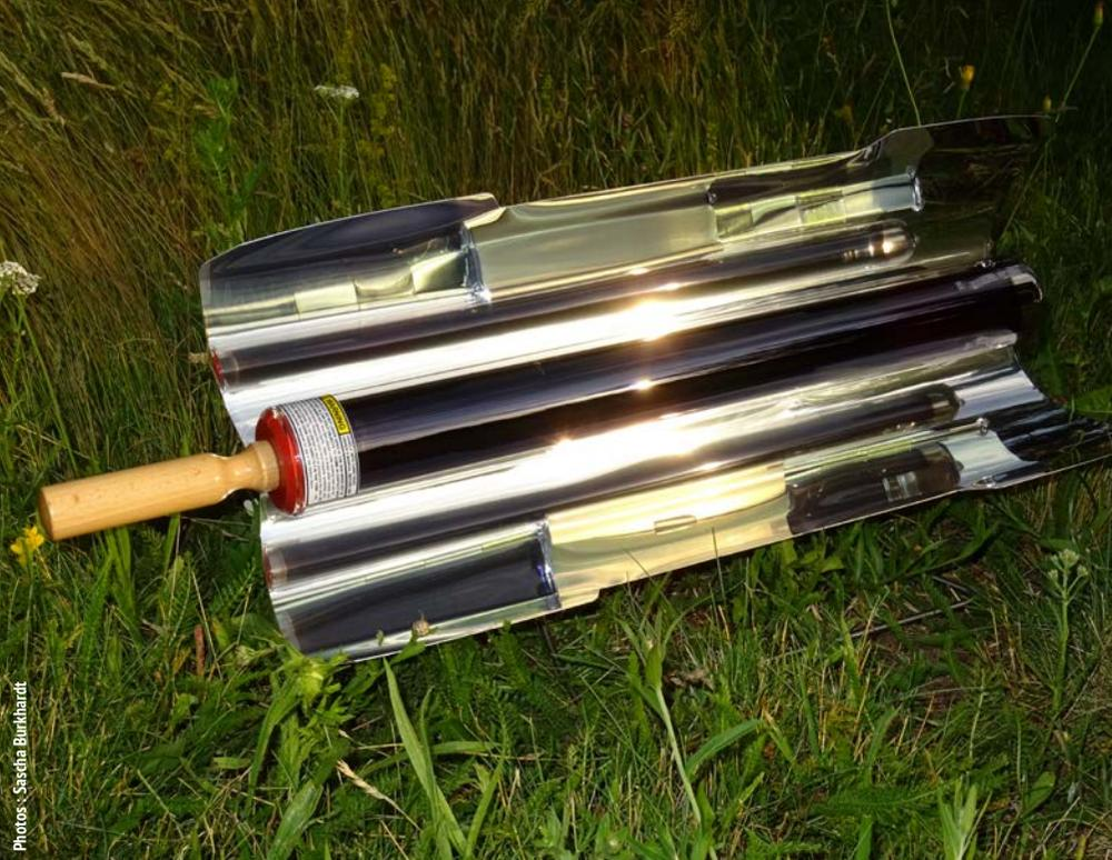
Die Spiegel konzentrieren die Sonnenstrahlung auf einen doppelwandigen Glaszylinder. Die darin enthaltenen Schichten aus Aluminiumlegierungen, Stahl und Kupfer sind durch ein Vakuum nach außen wärmeisoliert.
