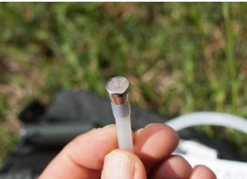
Der Ansaugschlauch mit Vorfilter.
