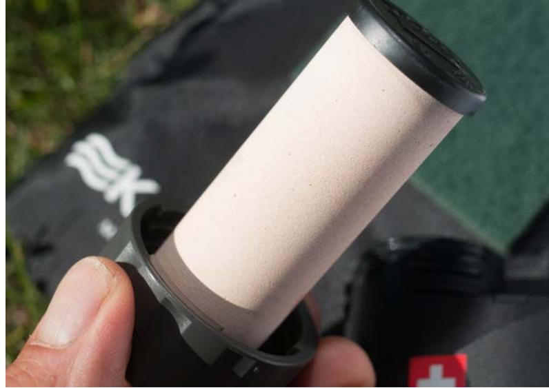
Der Keramikfilter mit 0,2 Micron (=0,0002 mm) kleinen Poren. Er muss regelmäßig mit dem Scheuerschwamm gereinigt werden und verliert so an Dicke. Nach ca. 7000 l soll Schluss sein, dann ist er zu dünn. 7000 l ist aber eine lange Zeit: wohl ungefähr 10 Tage Pumpen ohne Unterbrechung, Tag und Nacht...
