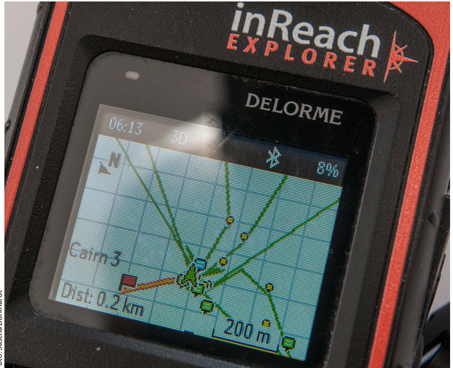
Der Navigationsbildschirm: Die Wegpunkte werden in einer einfachen Kartenansicht mit einer Kurslinie und der Trackingspur angezeigt.
