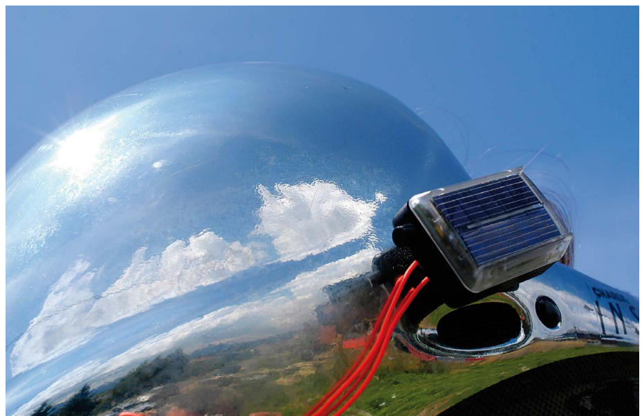
Im Freiflug ist ein Akustikvario eigentlich ein Minimum, was auch immer Hardcore-Paraglider-Puristen darüber denken mögen. Das Renschler Solario auf dem Bild ist ein Pionier, es kam vor über 20 Jahren heraus – und wurde schon ganz modern von Sonnenenergie gepowert, bevor diese Stromquelle "Mode" wurde. Man findet das Instrument immer noch bei manchen Händlern für ca. 140 €. Foto : Sascha Burkhardt
