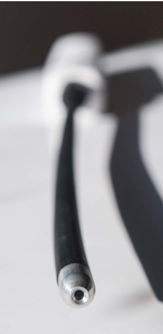
Die Öffnung des Pitot-Rohres des C-Probe.
