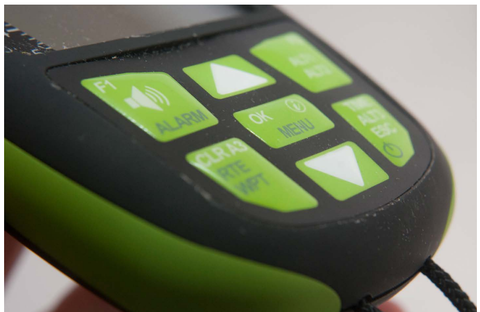
Die Tasten sind dank der Erhöhung einfach zu erfühlen.
