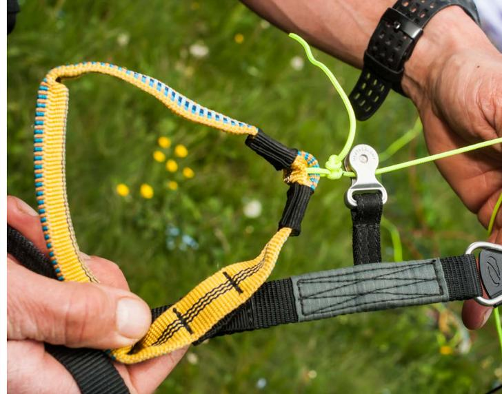
Der Bremsgriff und die metallische Umlenkrolle.
