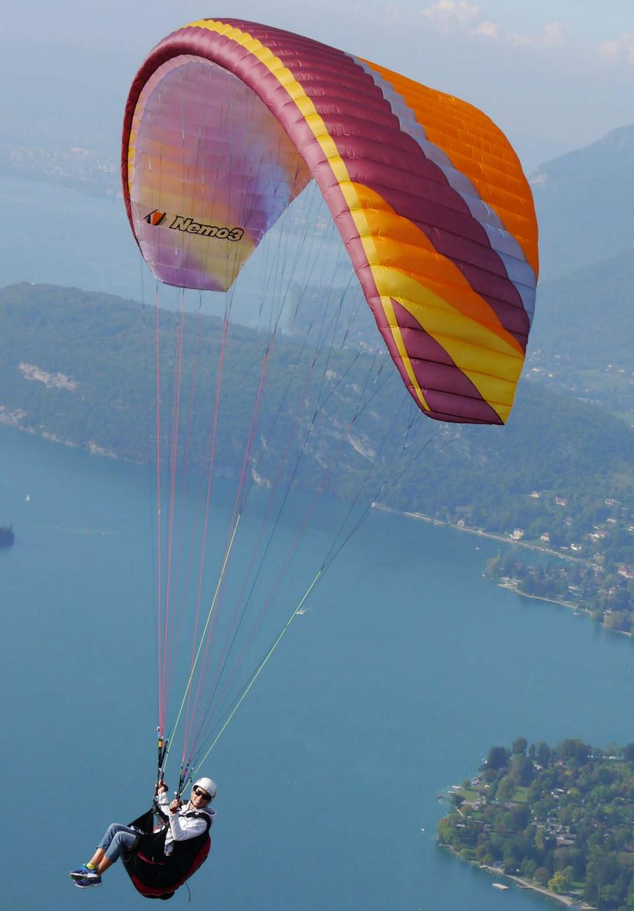
Der Nemo XX von Dudek gehört zu den Einsteiger-Kappen, die neue Trends setzen, indem Technologien aus den höheren Klassen integriert werden wie beispielsweise die deutlich sichtbare Sharknose.
