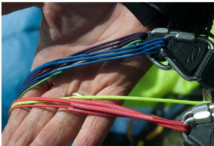
Beruhigend: fette Leinen, die sich leicht sortieren lassen. Auf der Redaktionswaage kam die Kappe Buzz Z4 PWR ML genau auf die Herstellerangabe von 5,6 kg.
