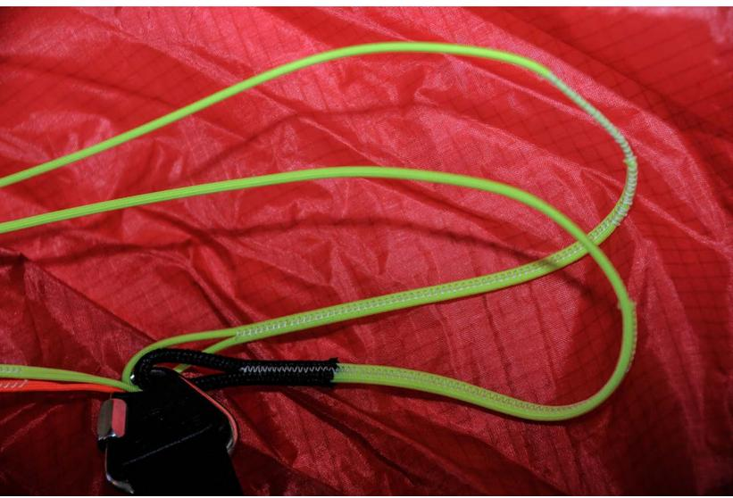
In der motortauglichen Version werden zwei C-Fangleinen verstärkt – ein einfacher Umbau., der jederzeit möglich ist.
