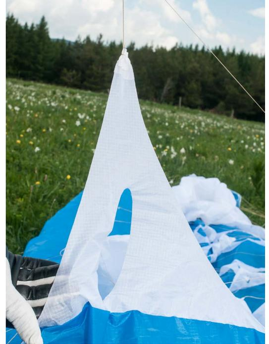
An allen Einfachsegeln werden die Kräfte sichtbar von dreiecksförmigen Rippen ans Obersegel (das auch Untersegel ist) geleitet.
