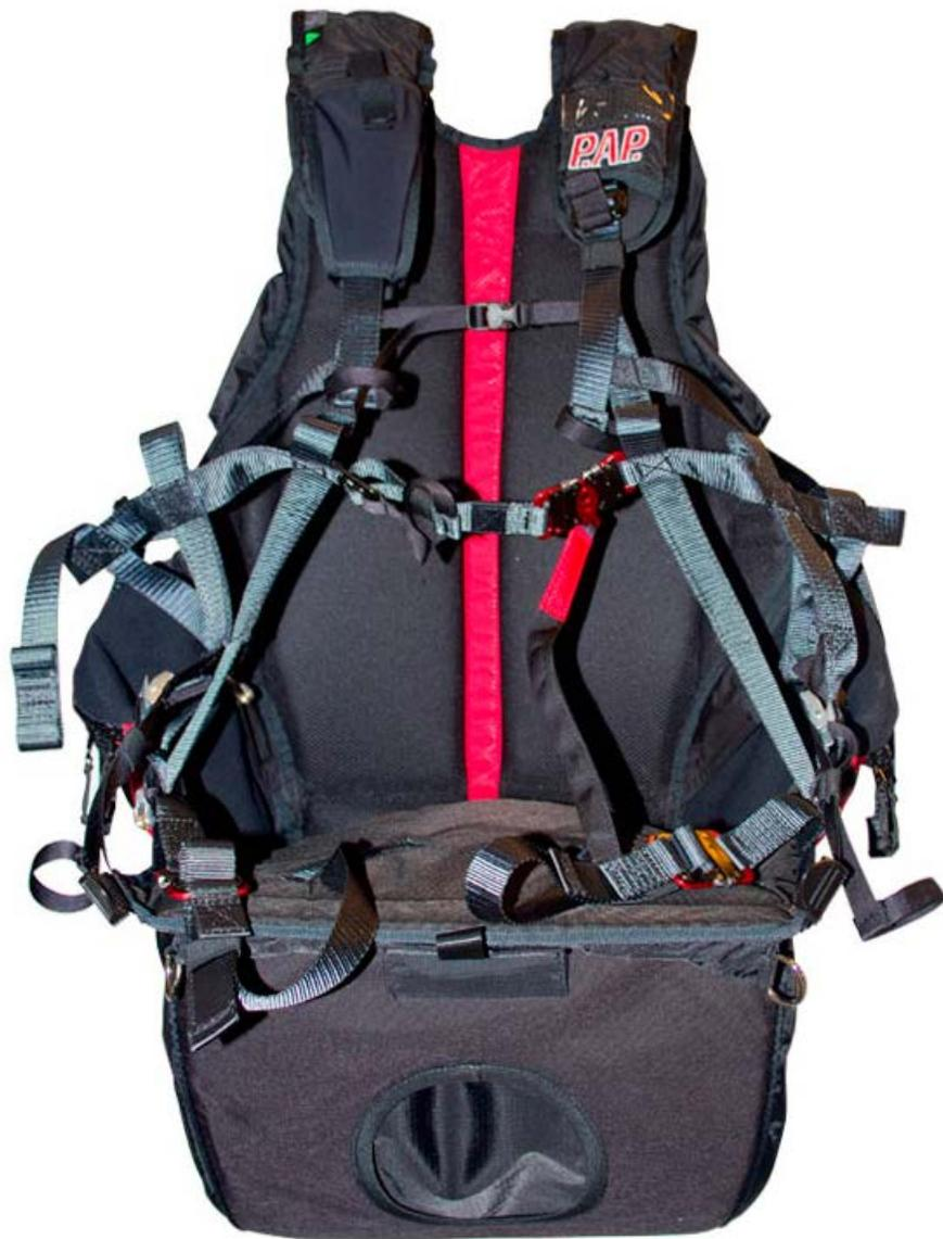
Laut PAP stört der Airbag weder beim Start noch in der Luft, und auch die Nutzung des Beschleunigers sowie der Transport am Boden seien nicht im Geringsten beeinträchtigt. Der Einsatz von Stoffen neuester Technologie soll das Gewicht im Vergleich zu einem klassischen Sitz nur um 200 Gramm erhöhen.
