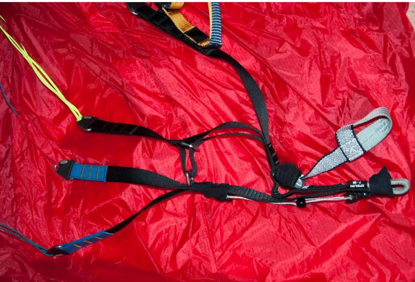
Der Trimmer-Tragegurt ist, wie häufig bei klassischen Hybridschirmen (Freiflug und Motor) so vorgesehen, dass der Pilot im Motorbereich nur den Trimmer nutzt und im Freiflug nur den Fußbeschleuniger - eine kombinierte Nutzung würde sonst die Eintrittskante gegenüber Frontklappern etwas zu sehr schwächen.
