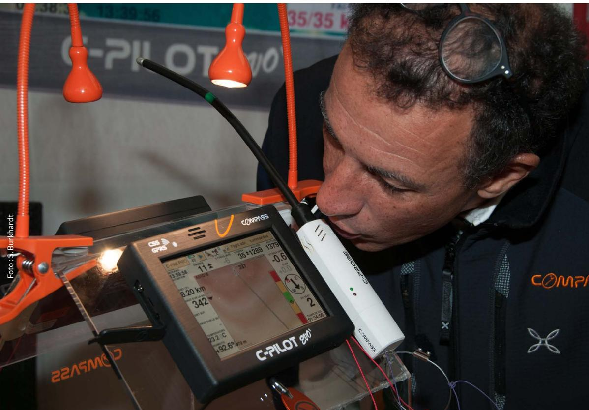
Hier der klassische Speedsensor "für jedermann". Auch er enthält ein Hygrometer, um die Luftfeuchte in die Berechnungen einfließen zu lassen, dies soll die Präzision erhöhen..
