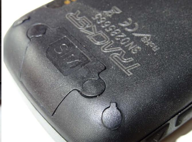
In dem wasserdichten Gehäuse ist eine SIM-Karte integriert, der Pilot soll dieses Fach eigentlich nie aufmachen.
