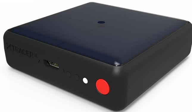
**D**er XCTracer II ist eine neue Version in der Instrumentenreihe von Koni Schafroth: Es kombiniert die weitreichenden Fähigkeiten des XCTracer 1 (Integriertes GPS, Bluetooth-Kommunikation mit Smartphones oder Tablets, IGC-Flugaufzeichnung und natürlich verzögerungsfreies Vario dank "Attitude Heading Reference System"), mit der Solarspeisung des XCTracer Mini.
