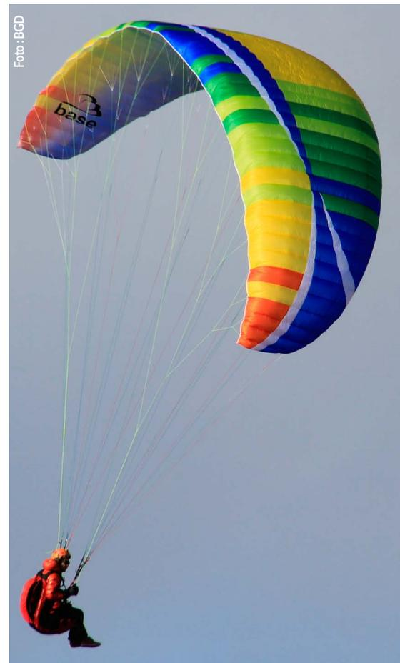
Bei BGD ist der High-End EN B Base jetzt homologiert. Mit insgesamt 90 Zellen (wenn man die Minizellen zwischen den Miniribs ganz frech mit zählt ...) wiegt er 5,3 kg in der Größe M (Foto oben). Die Vmax soll 55 km/h betragen, die Kappe ist in S, M, ML und L zu bekommen.
