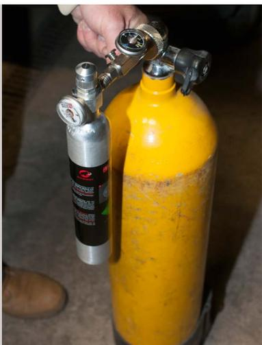
Nur der schwere Pressluftbehälter kann vom Nutzer selbst wieder befüllt werden (zum Beispiel im Tauchshop oder beim Paintball-Verein), die anderen Kartuschen müssen zum Hersteller oder in einer Servicestation ausgetauscht werden.
