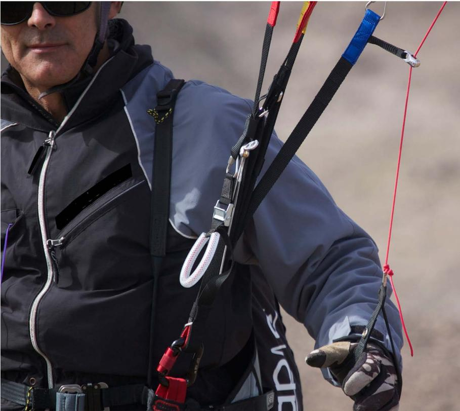
Der französische Hersteller arbeitet an einem neuen Schirm, der in erster Linie für den Einsatz an Küsten gedacht ist: Die Kappe ist schnell und mit Trimmern am ... vorderen Tragegurt ausgerüstet! Diese können zusätzlich zum Fußbeschleuniger eingesetzt werden, der einen etwas größeren Arbeitsbereich bietet. Der Pilot kann also eine gewisse Grundbeschleunigung einstellen und diese dann durch Betätigen des Fußbeschleunigers punktuell bei Bedarf erweitern.
