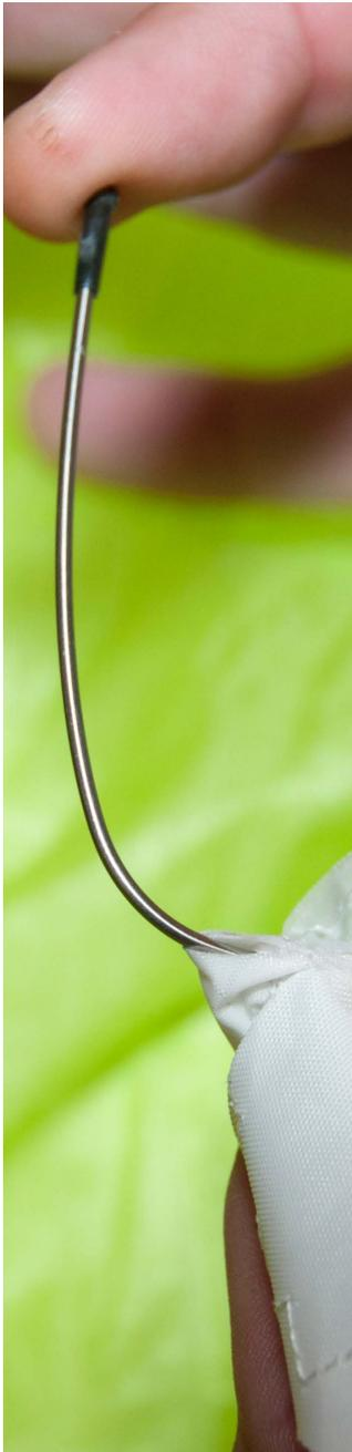
Nitinol ist eine Nickel-Titan-Legierung mit "Formgedächtnis" und könnte den Gleitschirmbau weiter revolutionieren, insbesondere als Ersatz für die Kunststoffdrähte (oft auch unpassend "Stäbchen" genannt.)
