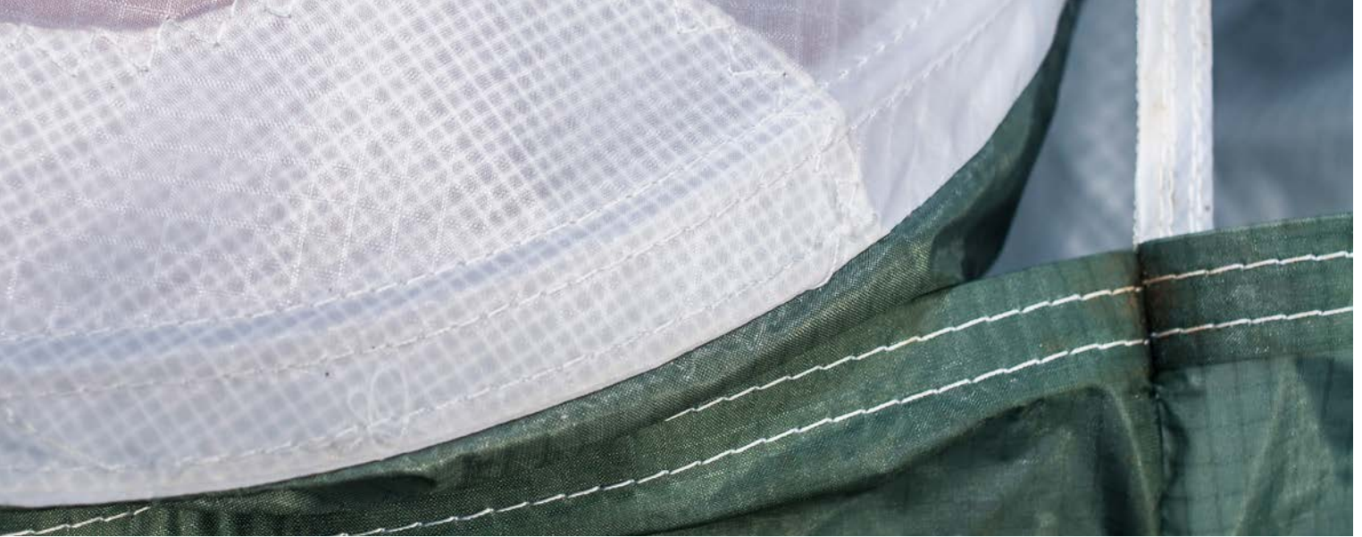
Snake 1: Mylar und Kunststoffdrähte, aber keine SharkNose
