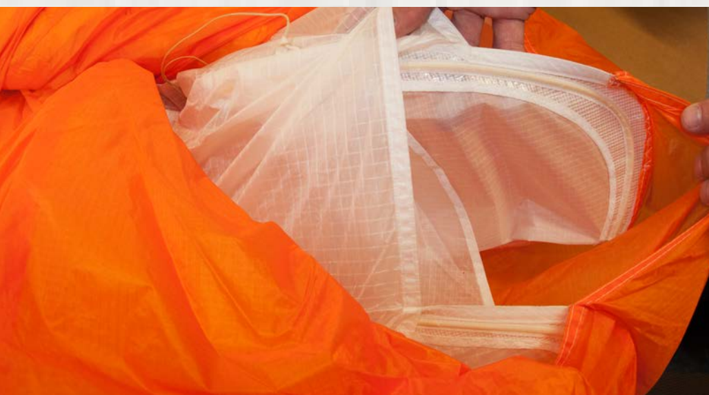
Hier an diesem Niviuk-Schirm von 2014 sind die Kunststoffdrähte das entscheidende Element, das die "Nase offenhält"...
