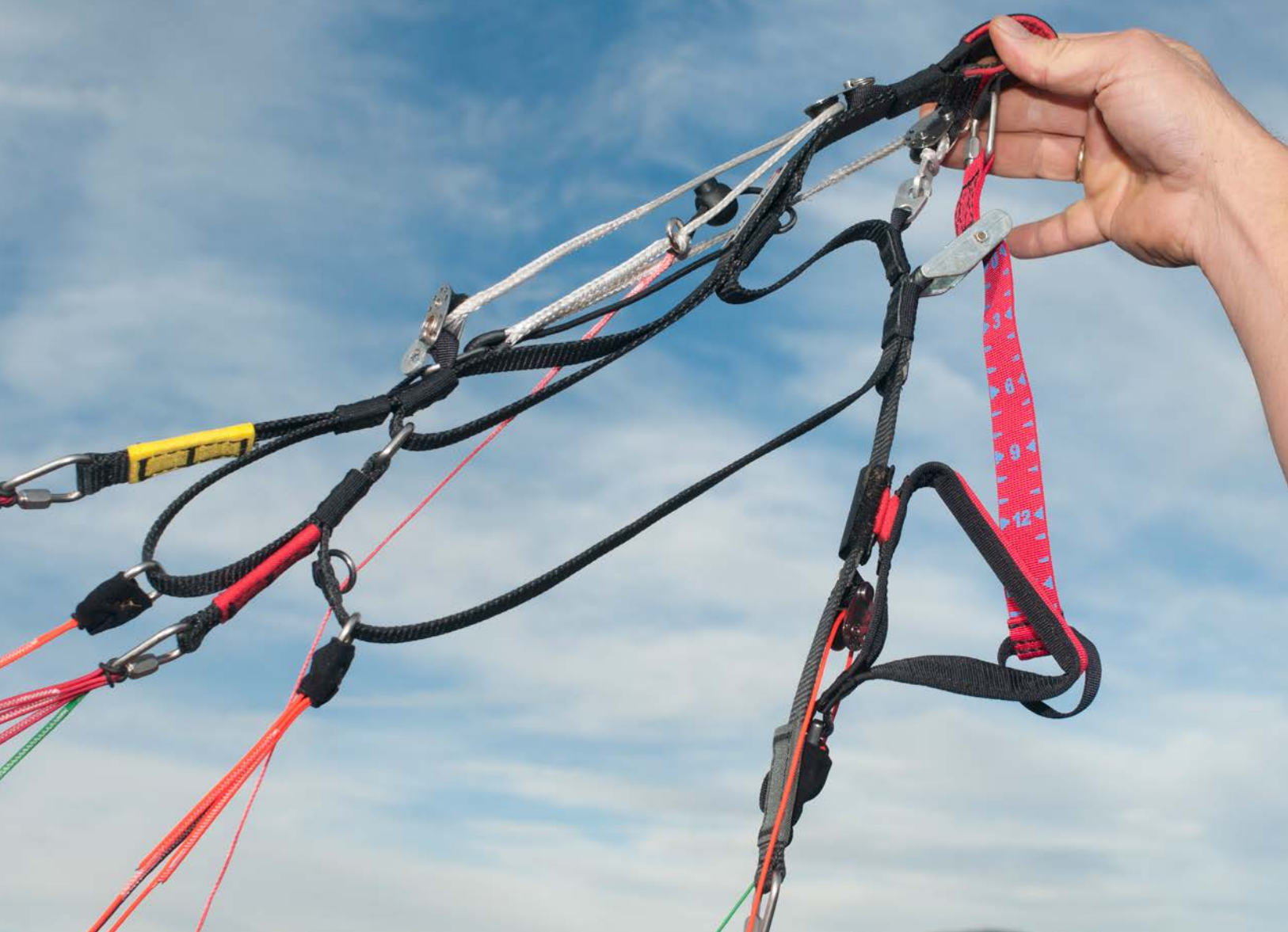
Effizienter Tragegurt, typisch für solche Reflexschirme, mit einem weiten Trimbereich.
