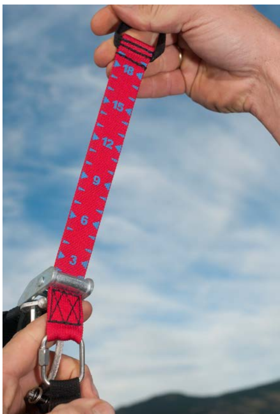
Effizienter Tragegurt, typisch für solche Reflexschirme, mit einem weiten Trimbereich.
