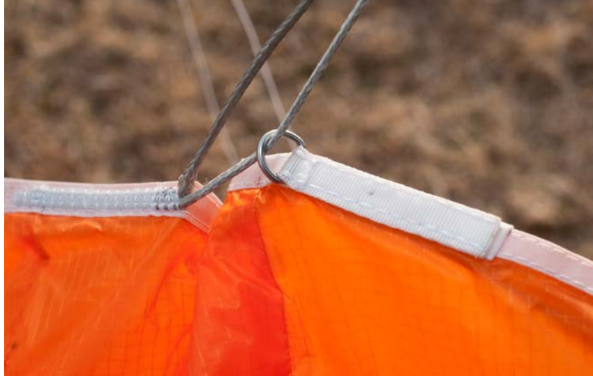
Eine klassische Technik, die sicherlich zum exzellenten Handling beigetragen hat: Raffleinen an der Ausströmkante.
