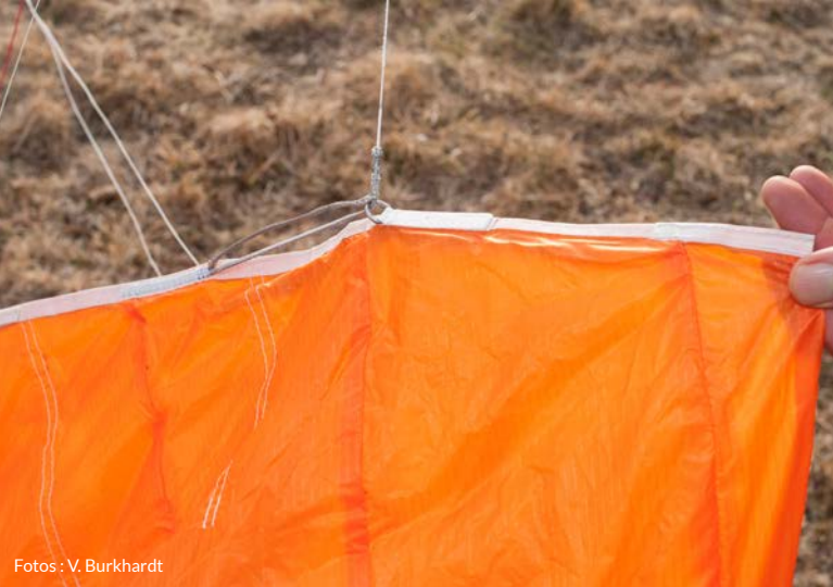
Eine klassische Technik, die sicherlich zum exzellenten Handling beigetragen hat: Raffleinen an der Ausströmkante.
