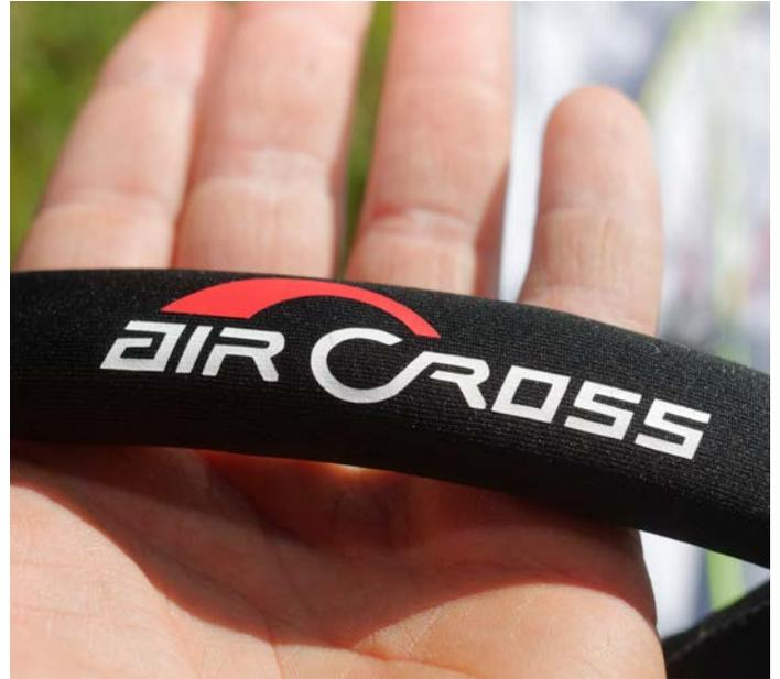
Angenehmes Detail: die gefütterte Bremsschlaufe.
