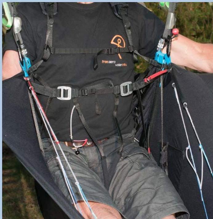
Das Advance Lightness 2 ([Test in free.aero](#)) ist mit einem GetUp-System ausgestattet, das über Plattenverschlüsse verschlossen wird. Fast narrensicher!
