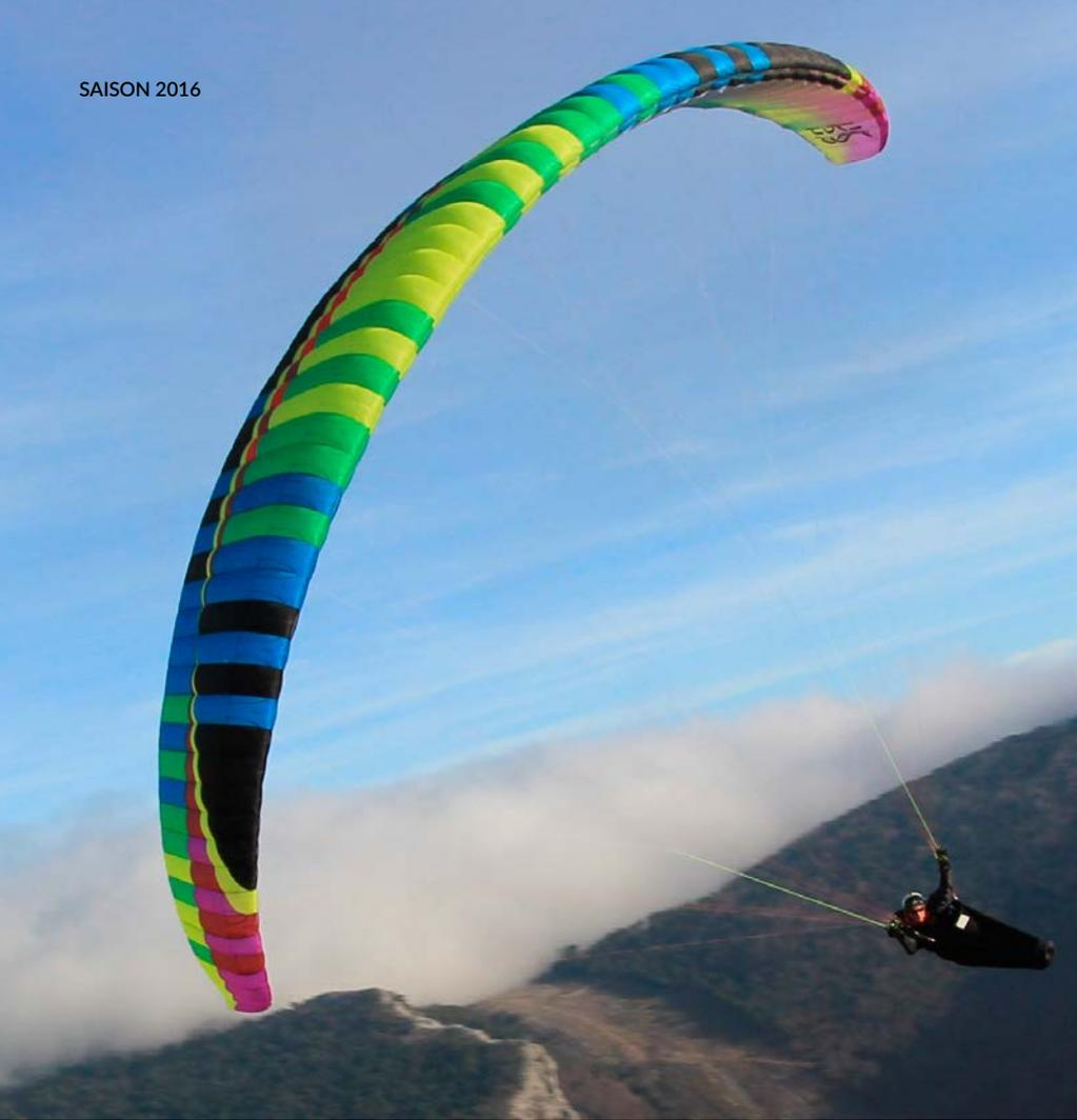
Der Mix von Obersegel aus Dominico N30 und Untersegel aus Porcher 27g/m<sup>2</sup> drücken das Kappengewicht auf angenehme 4,7kg in der M-Size. Die Shark Nose ist deutlich ausgeprägt..
