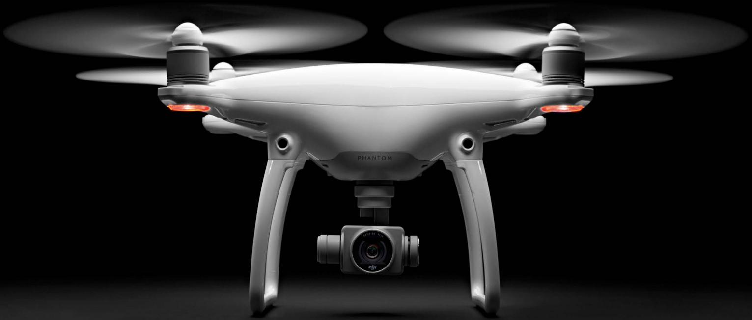
Der Phantom 4 von DJI ist dieses Jahr erschienen. Er ist mit einem Antikollisions-System versehen, das mit Videoanalyse und Ultraschall arbeitet. Er kann auch dank optischer Zielerfassung bewegte Objekte verfolgen.
