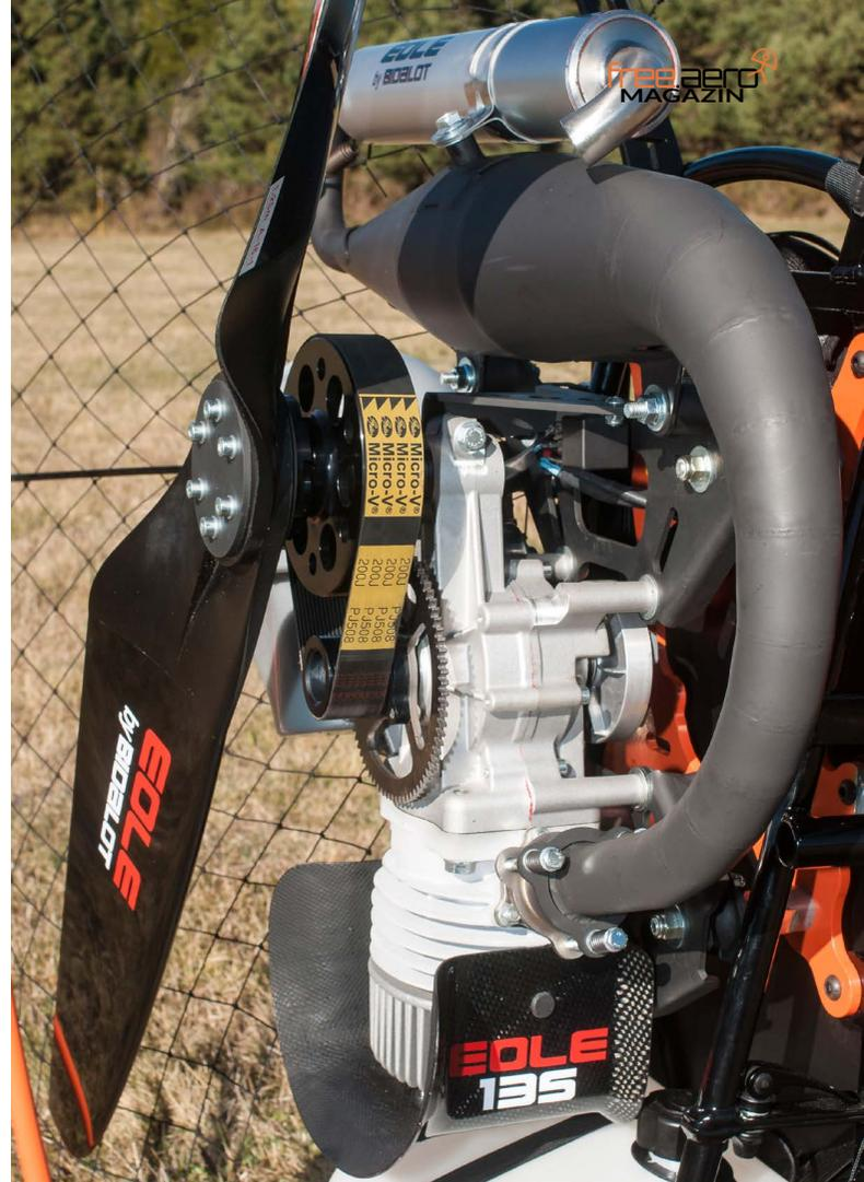
Die endgültige Version des Auspuffs: Über 15 Prototypen waren notwendig, um eine optimale Abstimmung zu erreichen. Das Resultat spricht für diesen geleisteten Aufwand.
