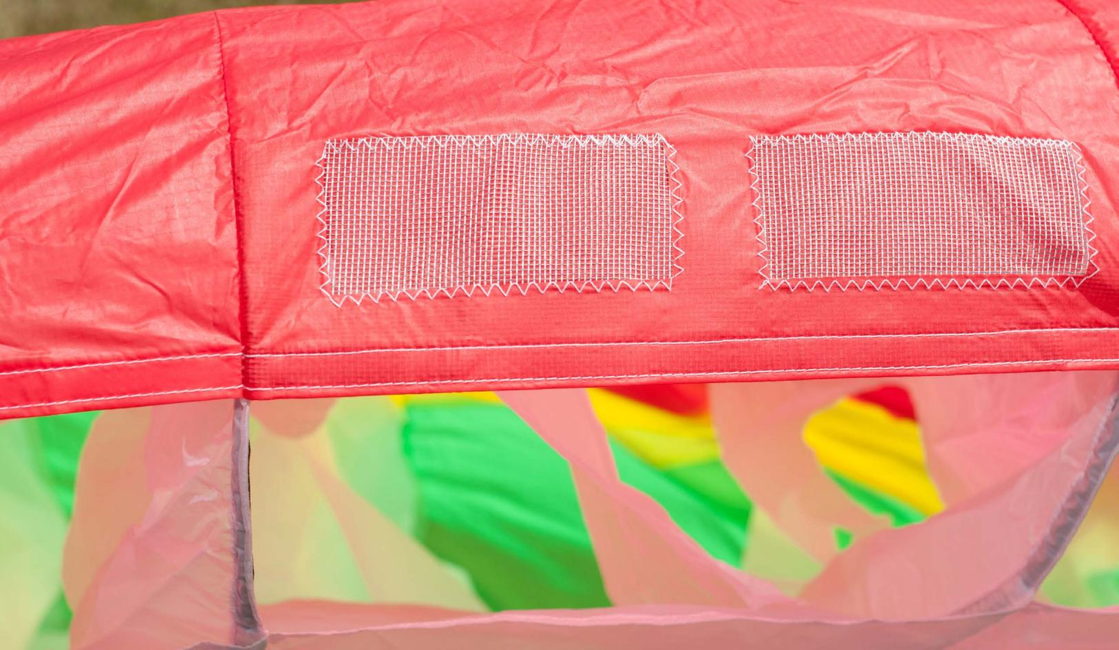
Auch an der Eintrittskante zeigt sich die gute Verarbeitung im Detail. Die Ventile "Hit Valves" sollen den Innendruck im Schnellflug erhöhen. Offenbar mit Erfolg, Apco konnte die Kappe 62 km/h schnell trimmen, das ist beeindruckend für einen Einsteigerschirm!
