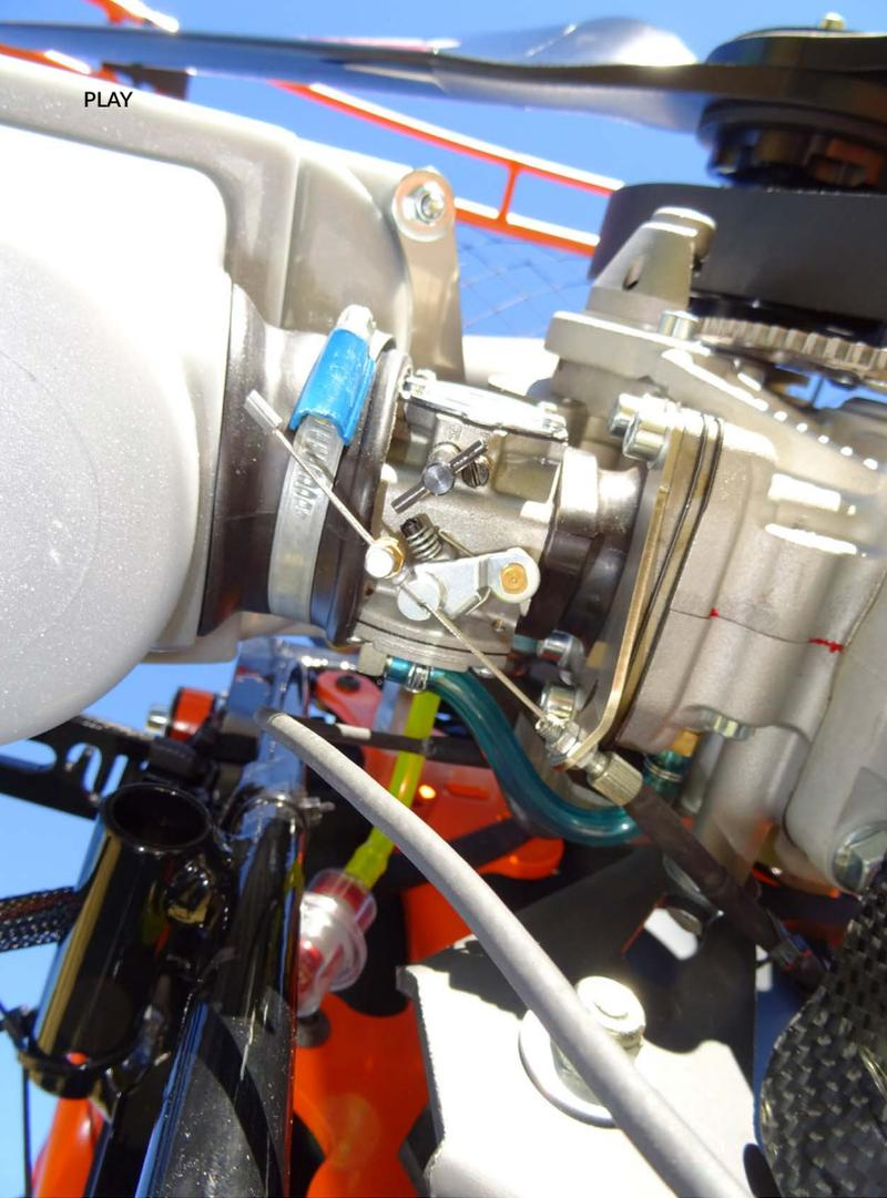
Der Membranvergaser Walbro: wie immer erfordern Membranvergaser zumindest bei der erstmaligen Abstimmung durch den Hersteller etwas mehr Fingerspitzengefühl als Schwimmervergaser. Dennoch verlangen viele Piloten, also die Endkunden, einen Membranvergaser. Ob das sinnvoller ist als der Einsatz von Schwimmervergasern, stellt ein ganz anderes Thema dar ...
