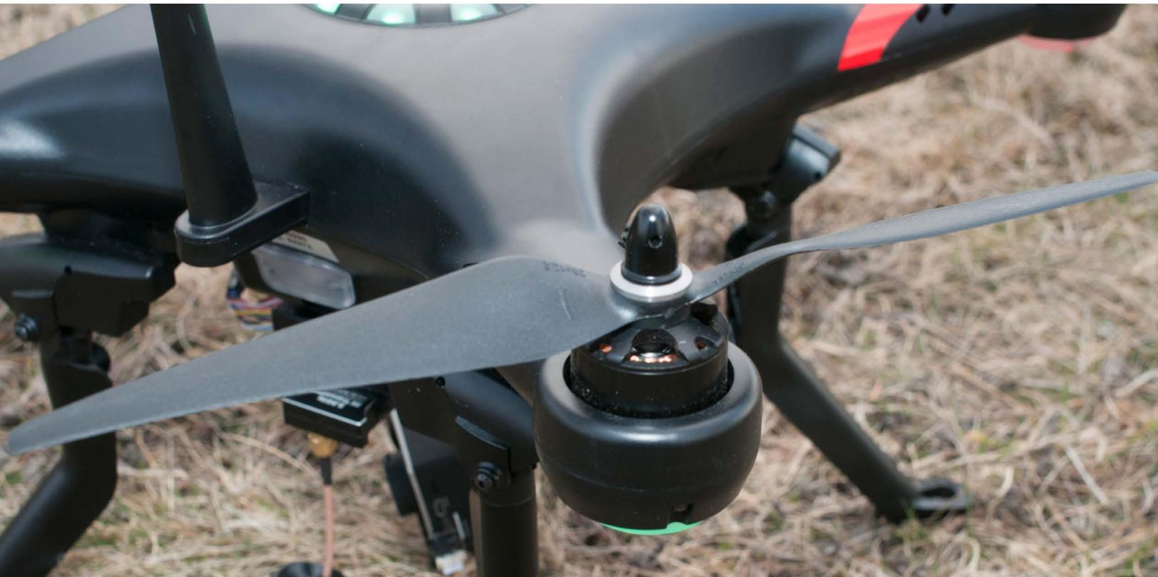
Vier Luftschrauben, die gegenläufig drehen, sorgen für einen ruhigen Flug. Nach einem Unfall sind die Propeller schnell zerstört, sie kosten aber nur 20€ (ein bisschen mehr als ein Zwanzigstel eines "echten" Motorschirmpropellers)
