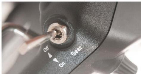
Besonderheit des Ghost: das Fahrwerk kann zu Gunsten eines ungestörten Kamerablickfelds nach oben eingefahren werden.
