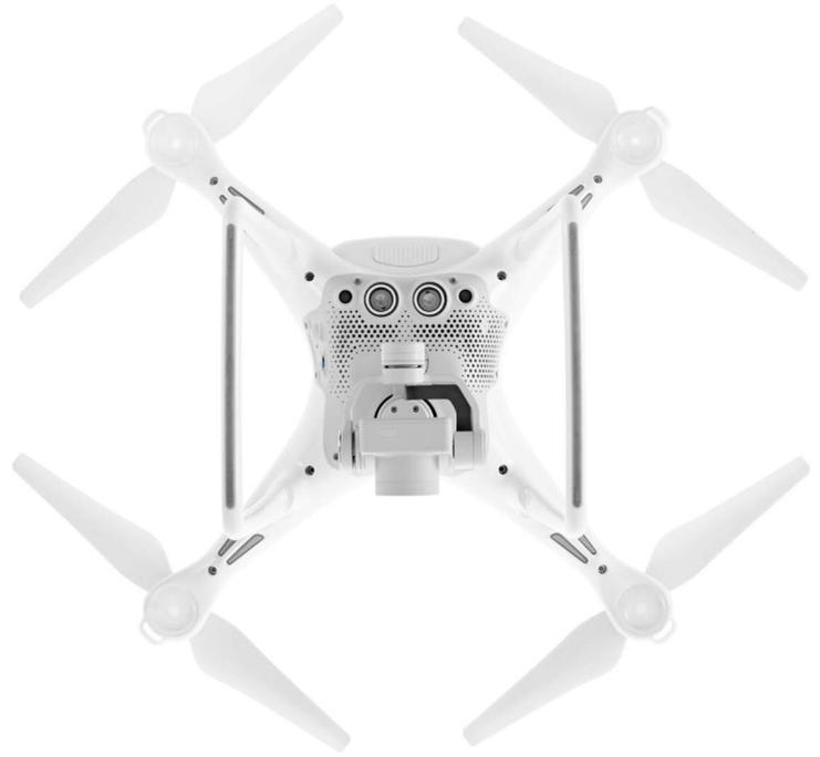
Nach unten werden die visuellen Sensoren (5 Kameras) mit Ultraschall-Sensoren ergänzt.
