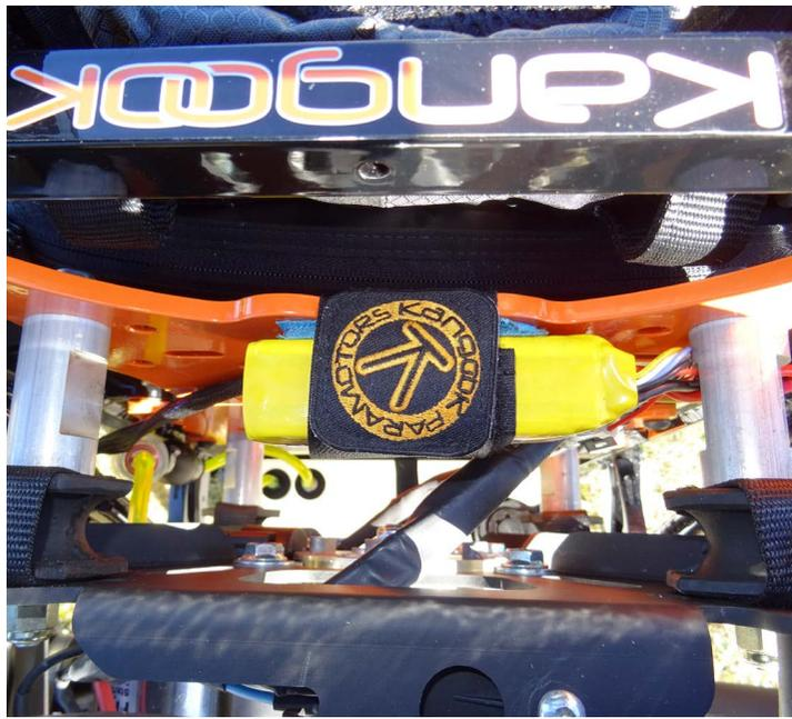
Der LiPo-Akku des e-Starters muss nach mehreren Dutzend Starts zu Hause nachgeladen werden, eine Lichtmaschine ist nicht vorhanden, das ist aber immer häufiger so zu sehen.
