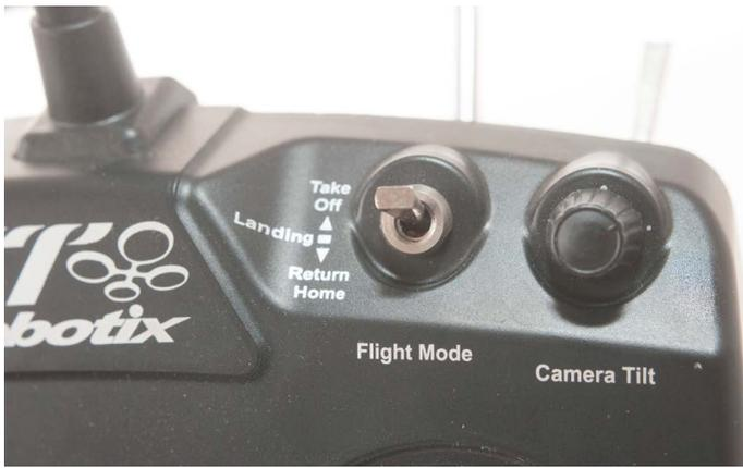
Mit dem Umschalter "Flight Mode" kann der Ghost zur automatischen, GPS-gestützten Rückkehr an den Ausgangspunkt beauftragt werden.
