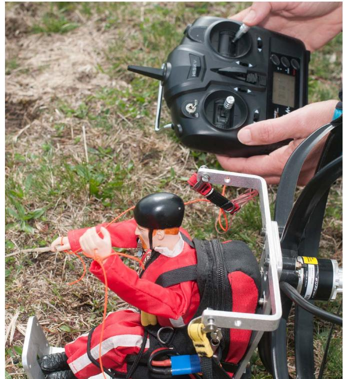
Für beidseitiges Anbremsen, zum Beispiel bei der Landung, ist der linke Knüppel da. Hier sind die Steuerbewegungen aufgrund des eingeschalteten "Anfängermodus" limitiert, man bekommt den Schirm so nicht gestallt.
