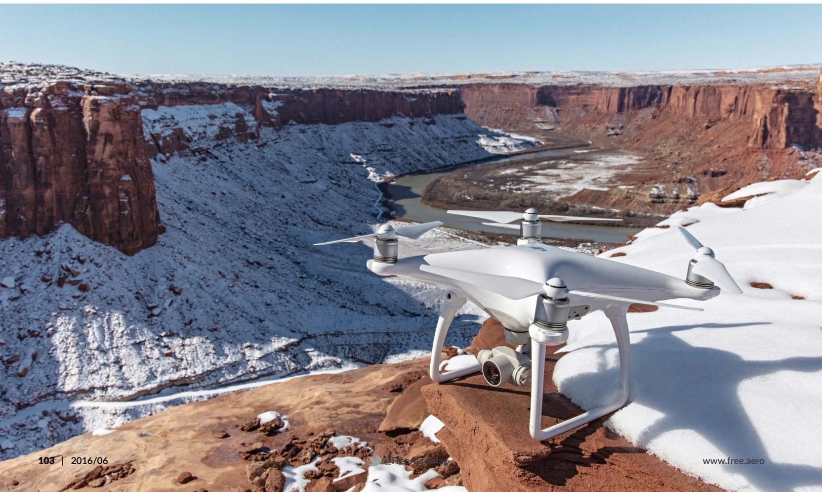
dafür sehr gut in den anderen Modi. Selbst wenn der Pilot es will, kann er da die Drohne nicht gegen eine Wand fliegen, das Gerät bleibt dank visueller Sensoren und Ultraschallsensoren einfach knapp davor stehen! Stromleitungen dagegen werden nicht unbedingt erfasst.
