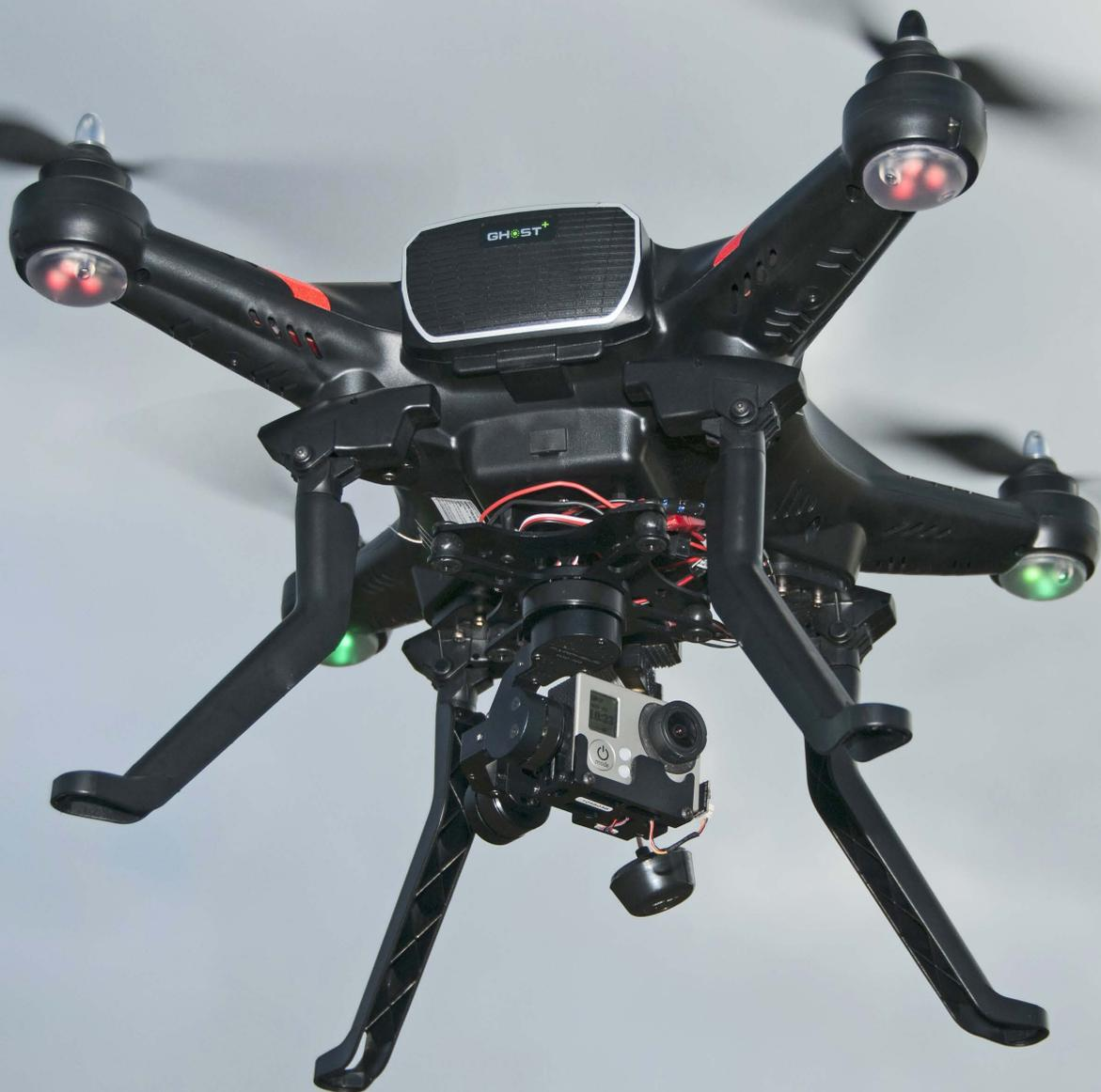
tion in der Luft stehen. Das Geheimnis liegt in der GPS-Positionsmessung sowie den Gyrosensoren und Beschleunigungsmessern. Jede kleinste Lageänderung wird vom Gerät sofort registriert und mittels Drehzahländerungen an den vier Luftschrauben automatisch ausgeglichen. Das Pilotieren einer Drohne ist entsprechend einfach, auch in turbulenter Luft.
