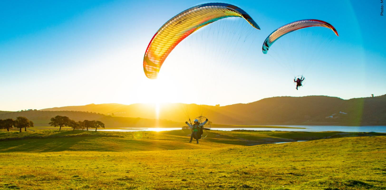
La nouvelle Piper de chez ITV a été massivement présente dans les paysages de Las Candelas. Une aile dont la Vmax serait de plus de 70 km/h. ITV l'a conçue comme "une aile polyvalente dédiée à la performance". La résistance à la turbulence de cette aile viendrait entre autres d'une nouvelle structure interne et d'un profil Shark Nose. Le gonflage serait facilité par un tissu plus léger sur les intrados. voler.info va la tester rapidement.
