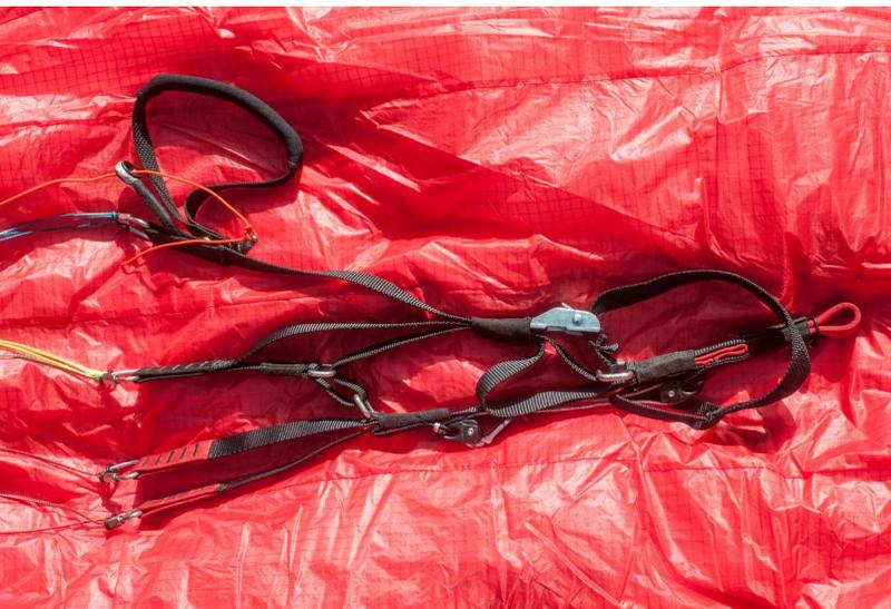
L'élévateur spécifique pour le moteur peut être utilisé en libre aussi. Dans ce cas, on doit uniquement utiliser l'accélérateur à pied, contrairement au moteur, où l'on est censé travailler aux trims uniquement
