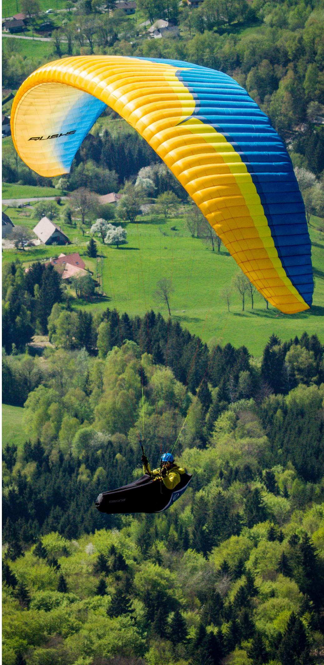
La position « mains basses » démontre un excellent comportement à basse vitesse, pour une repose au sommet. Le décrochage prévient largement, et démarre du bout d'aile. Dans les configurations limites, sorties du domaine de vol, genre mise en vrille, décrochage, la Rush 5 est académique, docile, et facile à remettre en forme, la rendant plutôt bien accessible pour sa catégorie "B plus".
