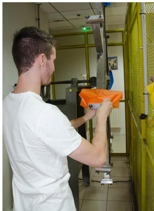
En battant dans le vent relatif du mouvement, le tissu subit des contraintes proches de l'utilisation réelle.
