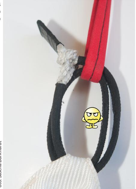
Un buen manual es esencial. Es igualmente importante que un eslabón blando sea atado doblemente. Por otro lado, en este ejemplo, la forma en la que está enhebrado a través de este lazo la primera vez, en el punto 4, no está bien. Pone un estrés innecesario sobre el sistema de amarre.
