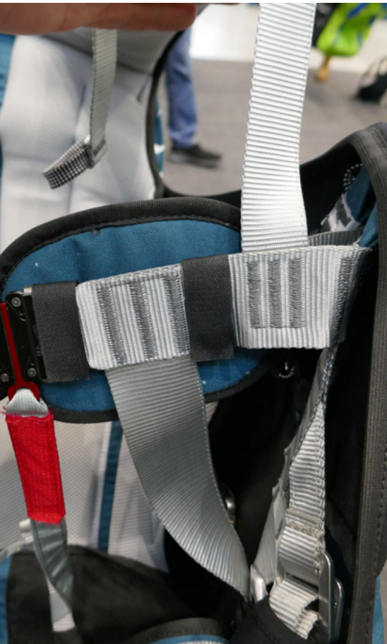
Kein Durchläufer, sondern Vernähung
