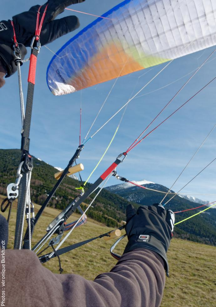
Der XChord füllt sich etwas zögerlicher. Im Vergleich dazu lässt sich der Zeno leichter beherrschen, er steigt freier und leichter auf, das Füllen ist mit den Bremsen leichter zu kontrollieren. Im Wind konnten wir dann trotzdem mit großer Präzision mit dem XChord spielen.
