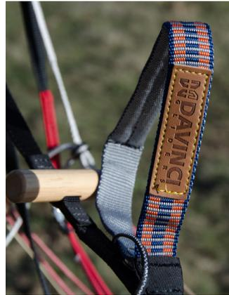
Detail : Steuergriffe aus Holz an den hinteren Tragegurten. Die Verarbeitung ist insgesamt hervorragend.
