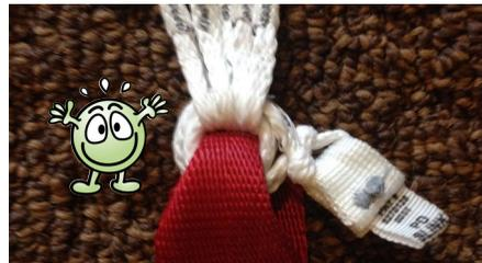
Ein Beispiel für eine gute Bedienungsanleitung. Das erneute Passieren durch das Auge in 4 ist allerdings nicht optimal, das belastet unnötig das Verschluss-Auge. Besser wäre, den Softlink bei der zweiten Umrundung einfach parallel zur ersten Runde zu führen.
