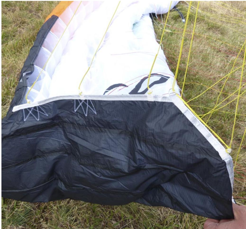
Eine Besonderheit bei Apco: Die Belüftungsventile für den Schnellflug.
