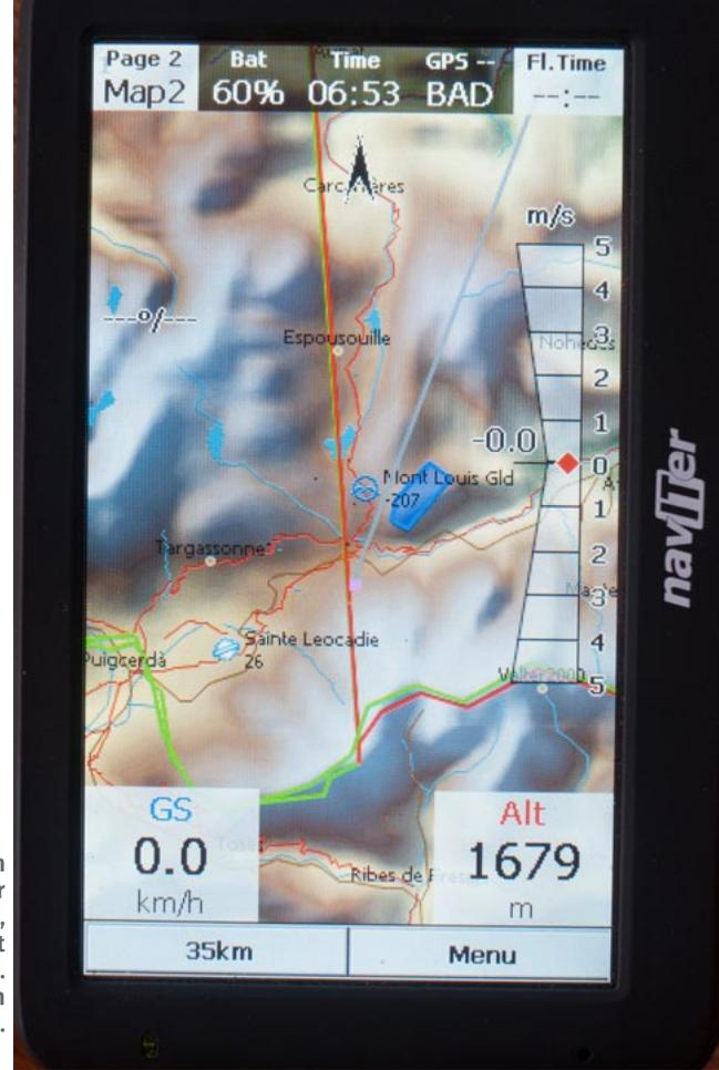
Das Compass C-Pilot Evo :ein hoch aufgelöster, taktile Bildschirm mit 640 x 480 Pixeln, der dementsprechend trotz erkennbarer Bemühungen im vollen Sonnenlicht wie hier etwas Kontrast einbüßt.
