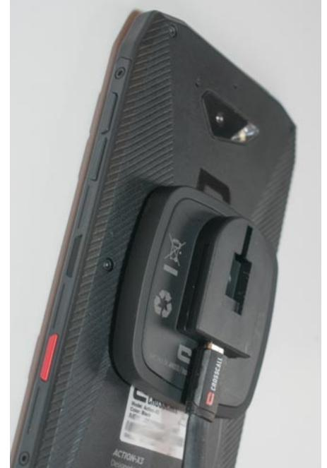
Die Magnetplatte des Car-Kit kann sowohl auf dem Cockpit als auch danach wieder im Auto verwendet werden. Diese Verbindung ermöglicht das Laden und sowie die USB-Verbindung mit dem Computer. Sie lädt übrigens deutlich schneller als die Induktionsladestation, wie sie beim Trekker X3 geboten wird. Dadurch, dass das Smartphone zusätzlich dank Magnet sicher fixiert wird, ist sie auch deutlich praktischer.
