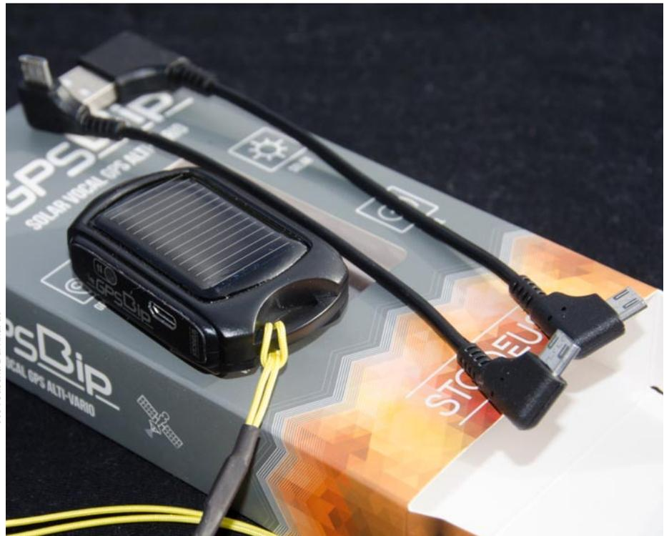
Das Akustik-GPS-Vario mit Solarspeisung kann per Kabel an Smartphones oder Tablets angeschlossen werden. Wir nutzen es vor allem als sehr praktisches Hike&Fly-Vario mit Sprachausgabe und hochauflösender Flugaufzeichnung.
