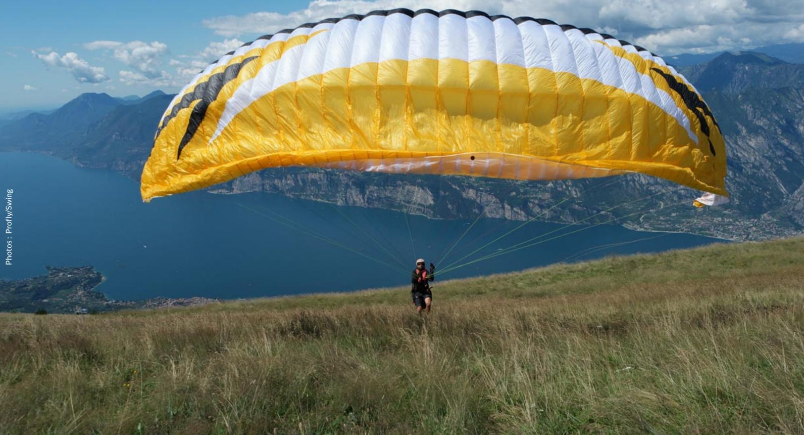
Beim Start gut zu sehen: der hintere Bereich des Schirms füllt sich mit Verzögerung. Das ist auch beim Motorfliegen ein Vorteil. Wir werden entsprechende Tests machen.
