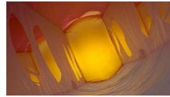
Der Swing Arcus RS positioniert sich in der Mitte der Klasse EN B und hat keine Shark Nose, sondern ein Profil, das durch einen recht kräftigen Draht aufgespannt wird. Der Konstrukteur Michael Nesler glaubt nicht wirklich an die Wirksamkeit einer Shark Nose im Bereich unterhalb von 50 km/h Fluggeschwindigkeit.
