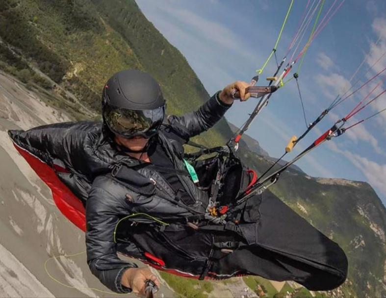
Ein sehr komfortabler Sitz mit einer hohen Effizienz auf der Rollachse. Das Genesis ist ein "Hängematten-Hybrid" mit Sitzbrett-ähnlichen Verstärkungen auf dem Protektor, der von sich aus schon eine hohe Steifigkeit aufweist.
