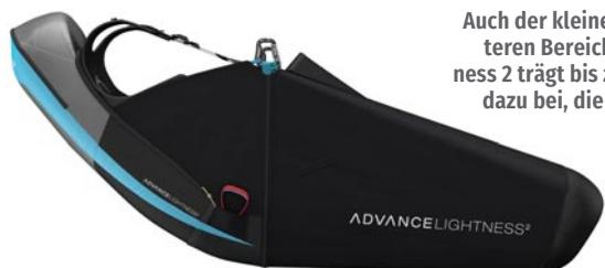
Auch der kleine profilierte Teil im hinteren Bereich dieses Advance Lightness 2 trägt bis zu einem gewissen Maß dazu bei, die Verwirbelungen im Lee des Piloten zu vermindern und damit den Luftwiderstand herabzusetzen. Übrigens kommt diesen Sommer noch das Lightness 3.
