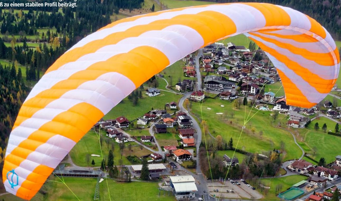
Die Steuerwege sind lang, um die 70 cm bis zum Strömungsabriss. Die Kurvenleitung erfolgt zügig mit einem leichten Zug an der Steuerleine, bei einem angenehmen leichten Steuerdruck. Schon dieser Punkt macht deutlich, dass der Schirm sich eher an einen Piloten mit einem gewissen Minimum von Erfahrung wendet. Das Handling bietet eine präzise Umsetzung der Befehle, die Kommunikation mit dem Schirm ist klar und deutlich. Dabei bleibt der Schirm über den gesamten Geschwindigkeitsbereich sehr stabil.
