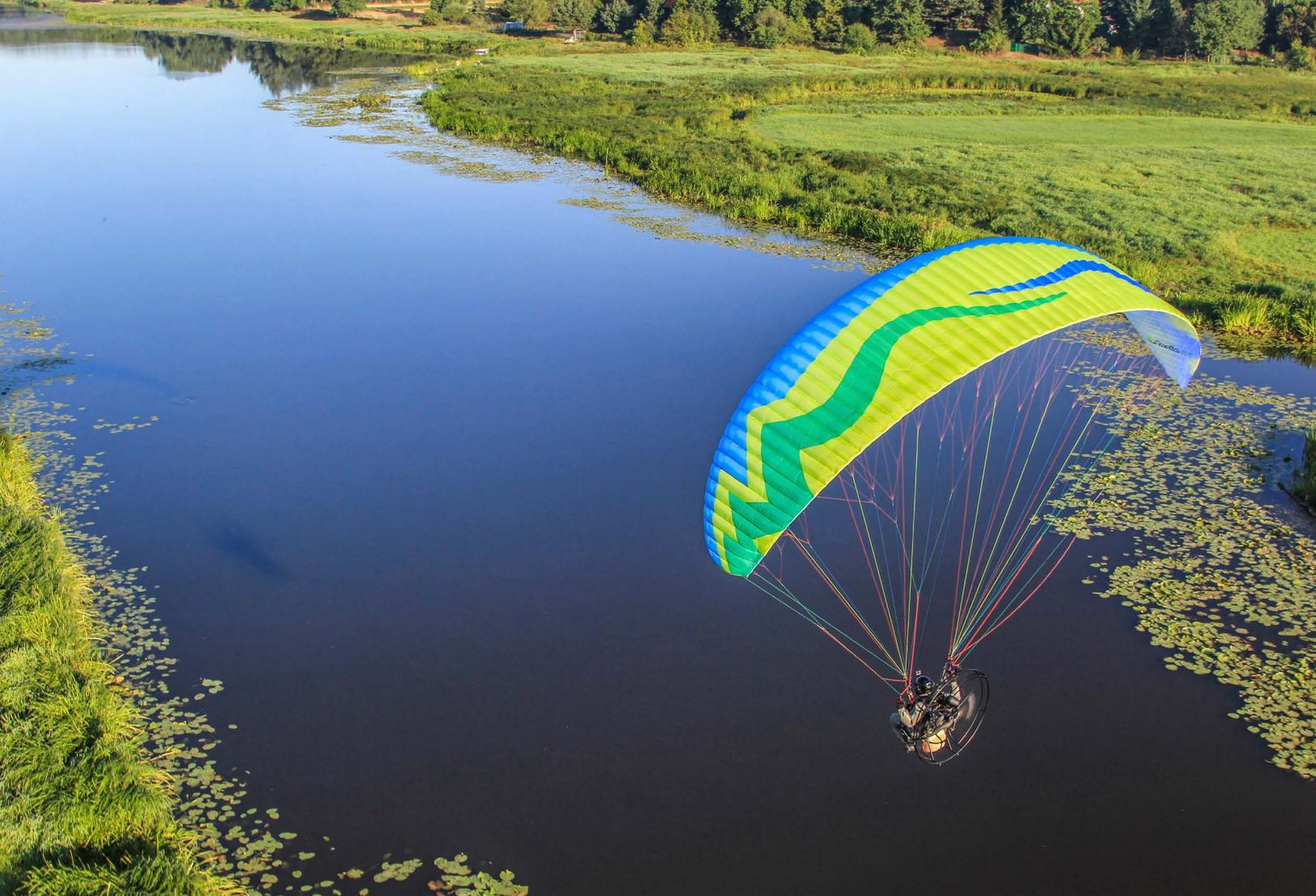
Sur une aile de paramoteur à profil reflex comme cette Dudek Snake XX, il est nécessaire de maintenir 4 éleveurs, entre autres pour régler les déformations voulues du profil.
