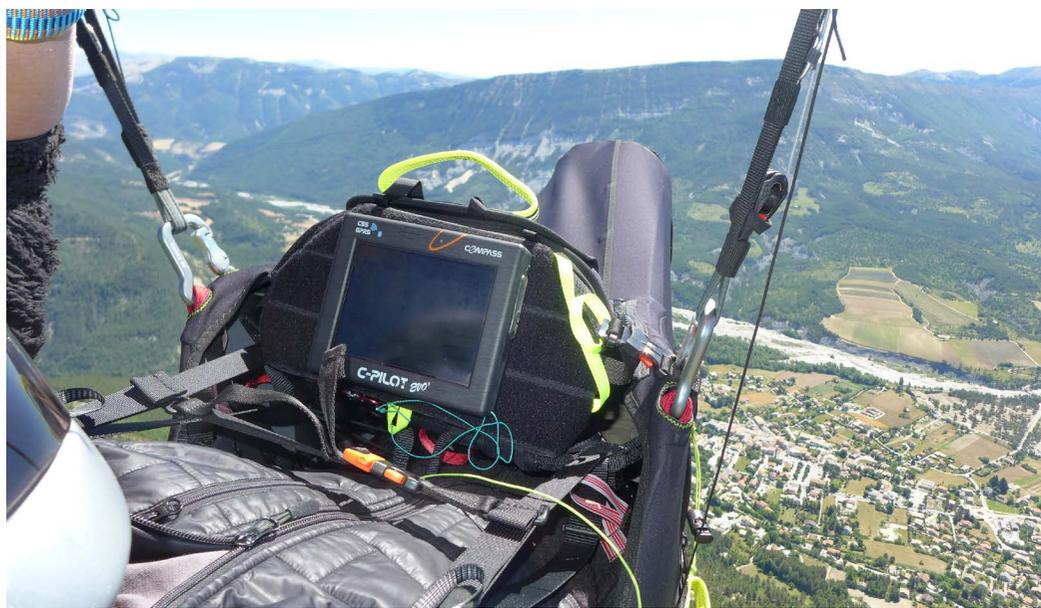
Le poste de pilotage est très compact, près du regard. Sous les mains, à droite une bonne poche zippée. Idem de l'autre côté, avec de plus, vers l'arrière, un rangement prévu pour le drag chute. Dans les détails, poche radio sur l'épaule, compartiment ballast, passages prévus pour le tuyau de gourde, le tuyau de vidange « penilex », et le tuyau ballast.
