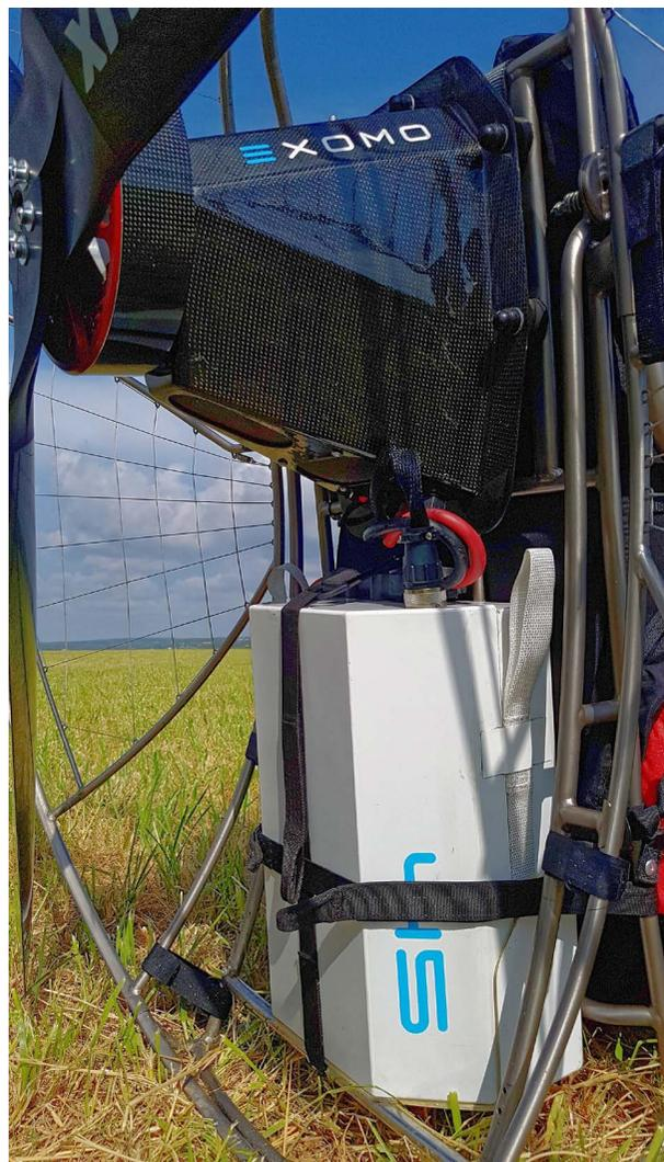
Le moteur est protégé par un cache en carbone très propre. En dessous la batterie loge dans une boîte blanche dont les poignées sont bien pratiques. Cette boîte est fixée par un système de velcro solide.
