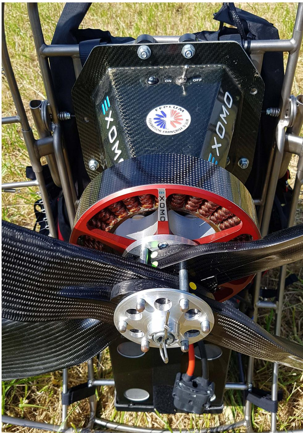
La prévol est réduite au minimum étant donné que le « cœur » du moteur électrique est protégé par un cache en carbone. Interrupteur général sur ON, un appui du pouce sur le bouton de la commande, trois secondes d'attente, un bip... et c'est parti!
