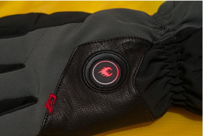
La LED en forme de flamme indique par sa couleur le niveau de chauffage choisi, de 0 à 3. Dans la plupart des conditions, le niveau 2 est largement suffisant et procure une autonomie d'environ huit heures.
