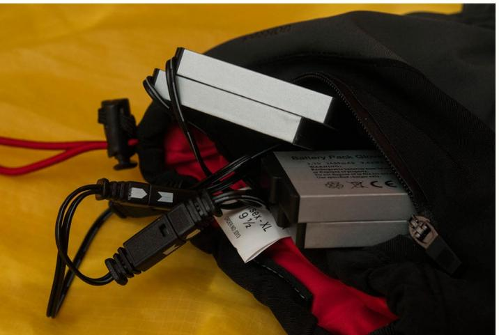
Pour le rechargement pendant la nuit, il suffit de défaire les connecteurs et de les brancher au chargeur livré avec les gants.
