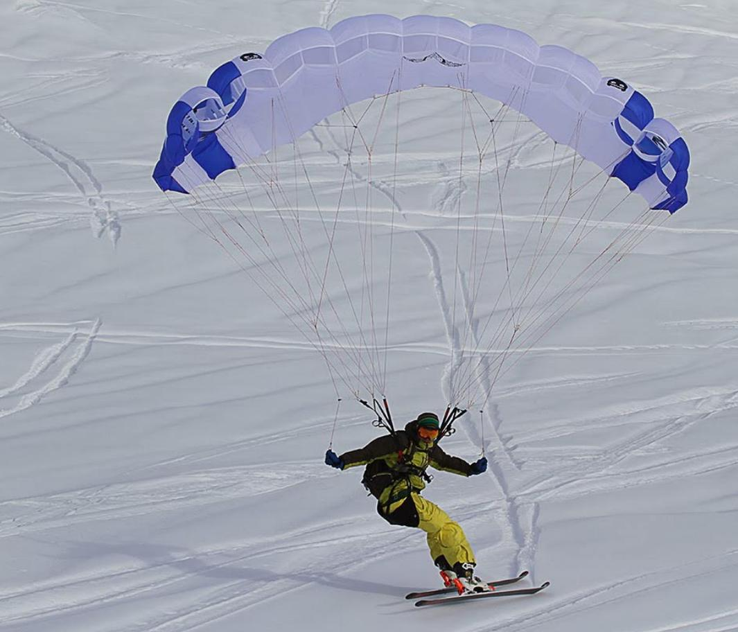
La Mutant : la voile de speed riding de Flying Planet avait été développée par l'inoubliable Antoine Montant. C'est une voile type parachute 9 caissons, avec un bord d'attaque très solide et tolérant. En position piquée des trims, elle offre un grand débattement à la commande.
