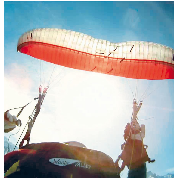
Réouverture "normale", symétrique et sur tout le bord d'attaque...
