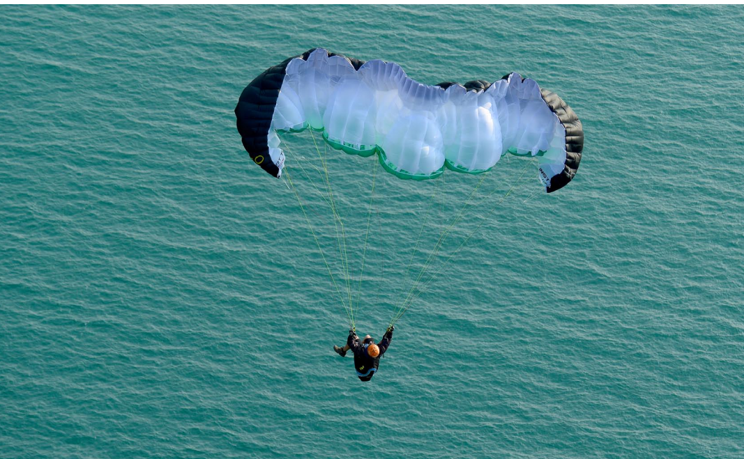
Le vent relatif appuie sur le bord d'attaque replié, quelques caissons se fauillent dans le suspentage de plus en plus ajouré des voiles modernes : un facteur de plus contribuant à retarder la réouverture.
