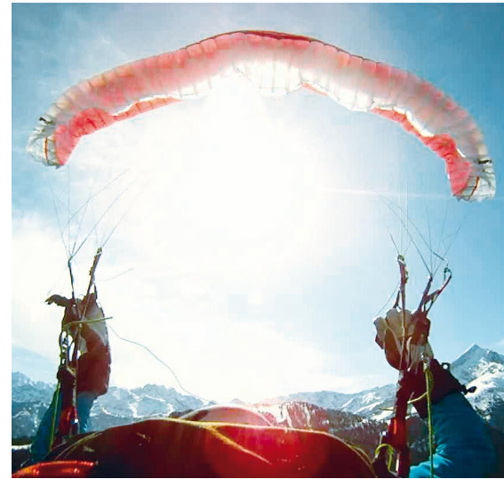
Réouverture "normale", symétrique et sur tout le bord d'attaque...
